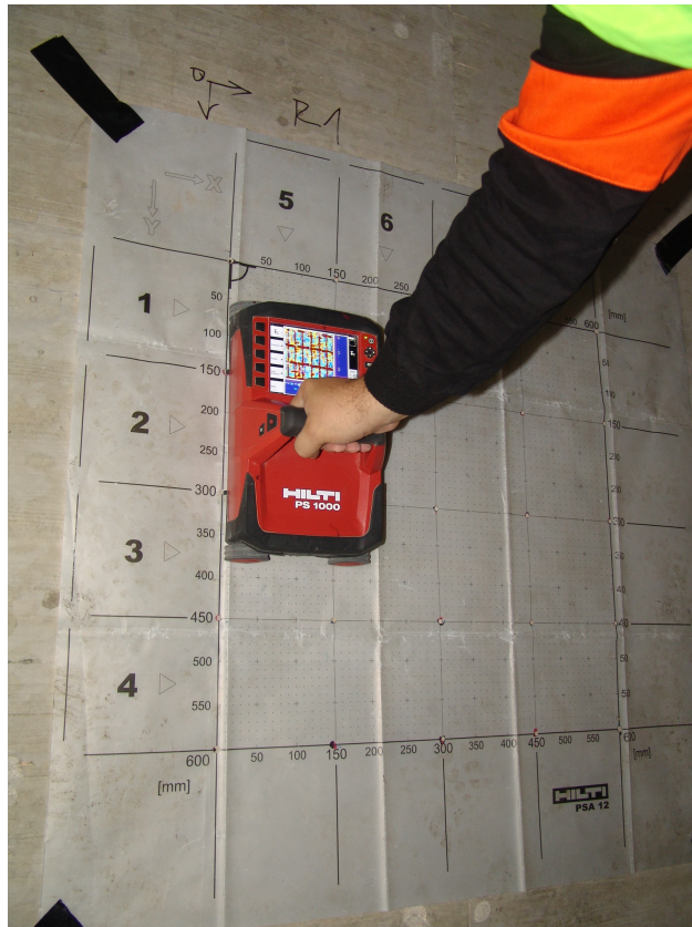
Obr. 9: Ukázka plošného měření radarem [F]
