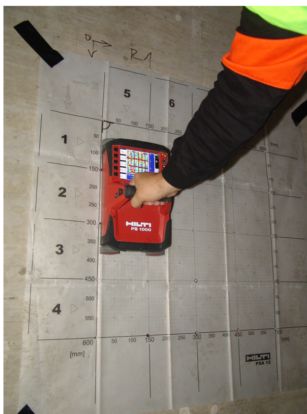
Obr. 9: Ukázka plošného měření radarem [F]
