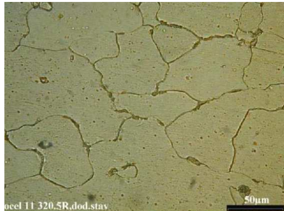
Obr. 5.2 Výchozí struktura oceli 11 320 5R \approx 500x zvětšeno [22]
