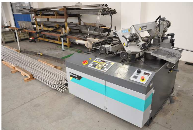
Obr. 6.20 Pásová pila PEGAS 290x290 A-CNC-F [16]
