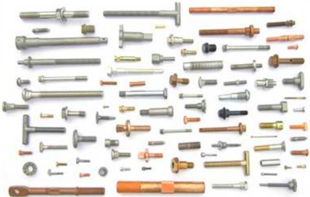
Obr. 4.1 Příklady součásti zhotovené objemovým tvářením za studena [24]
