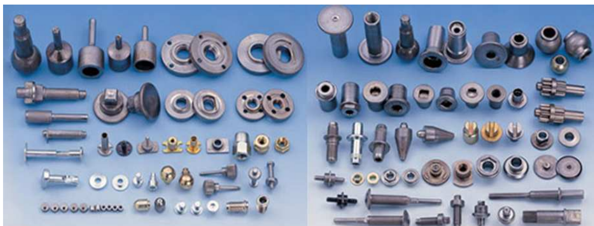
Obr. 1.2 Příklady součástí vyráběných objemovým tvářením za studena [18]
