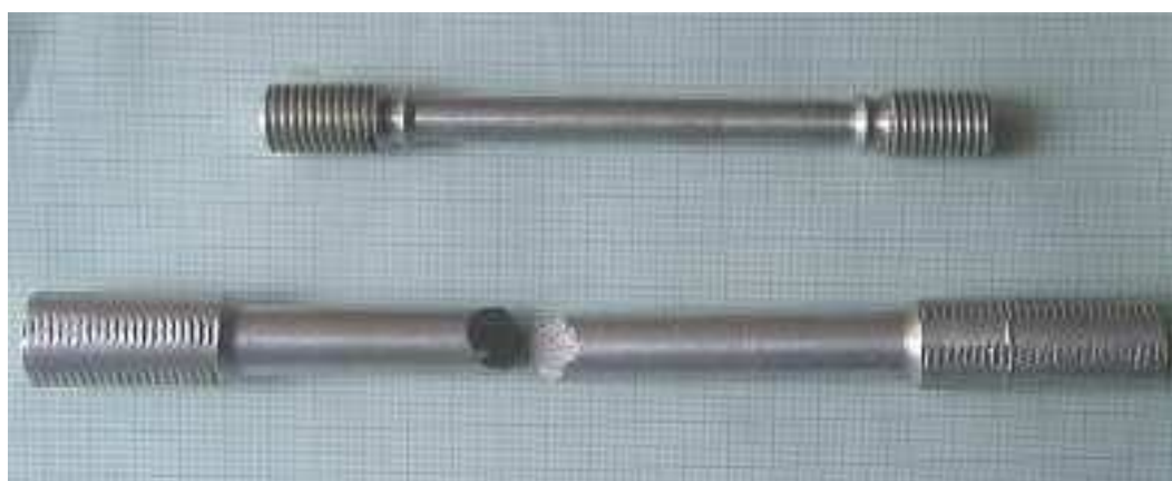
Obr. 3.3 Přetržená tyč z tahové zkoušky [19]
