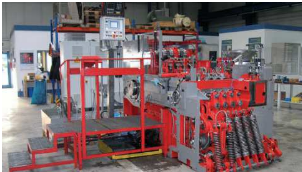
Obr. 7.1 Postupový tvářecí automat HATEBUR BKA-3 [20]
