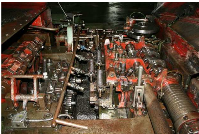
Obr. 7.2 Pracovní prostor tvářecího automatu HATEBUR BKA-3 [21]
