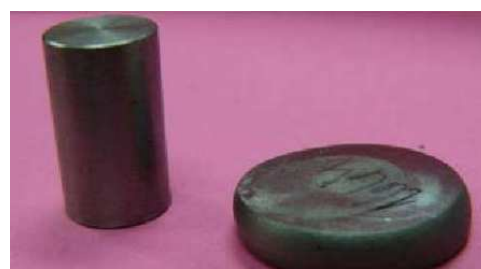
Obr. 3.6 Vzorek před a po pěchovací zkoušce [19]
