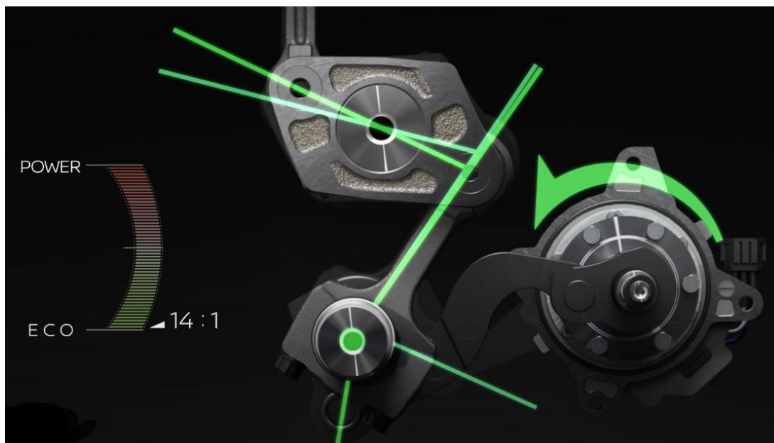
Obrázek 7 Úhly natočení VC mechanismu pro kompresní poměr 14 : 1 [5]
