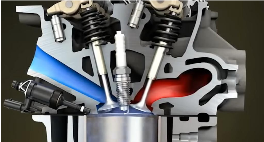
Obrázek 13 Řez hlavou válců Volkswagen EA 211 1.5 TSI evo2[66]
