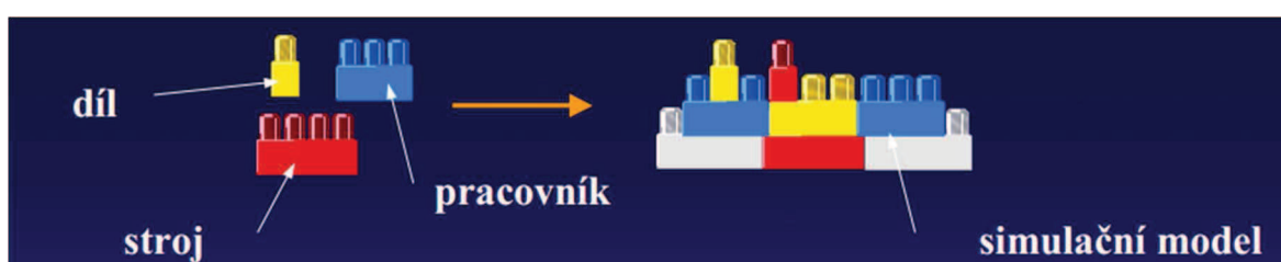
Obr. 10: Jednoduché schéma tvorby simulačního modelu
