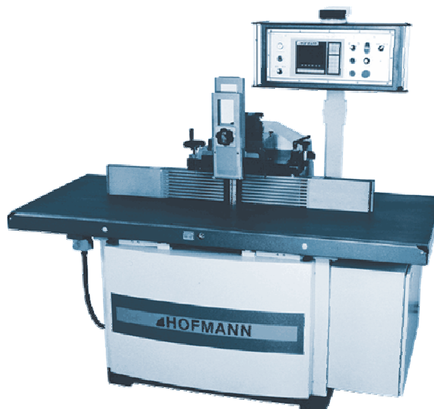
Obr. 1.2 Univerzální frézka s překlopitelnou hřídelí Hofmann UFM 210 VISION 4
