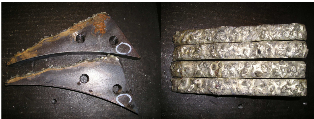
Obr. 5.12 Nůž s upraveným základním materiálem
