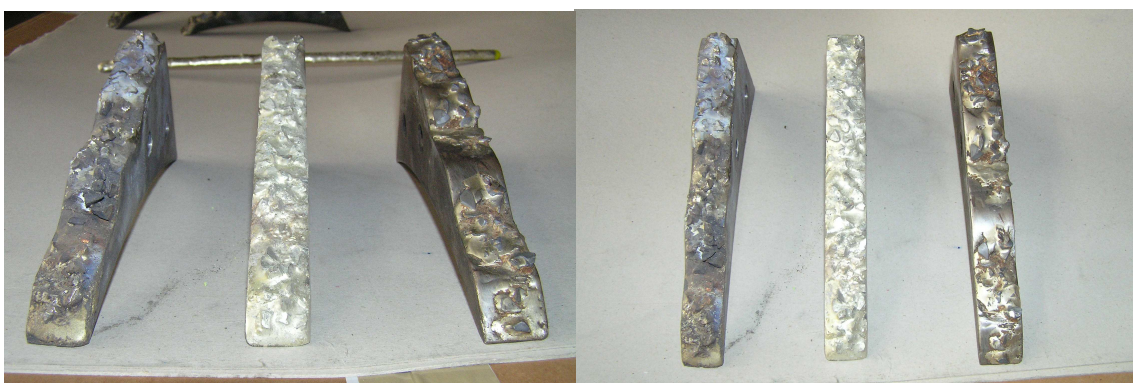
Obr. 5.9 Zleva: Chybně vyrobený nůž, kvalitně vyrobený nůž, opotřebený nůž
