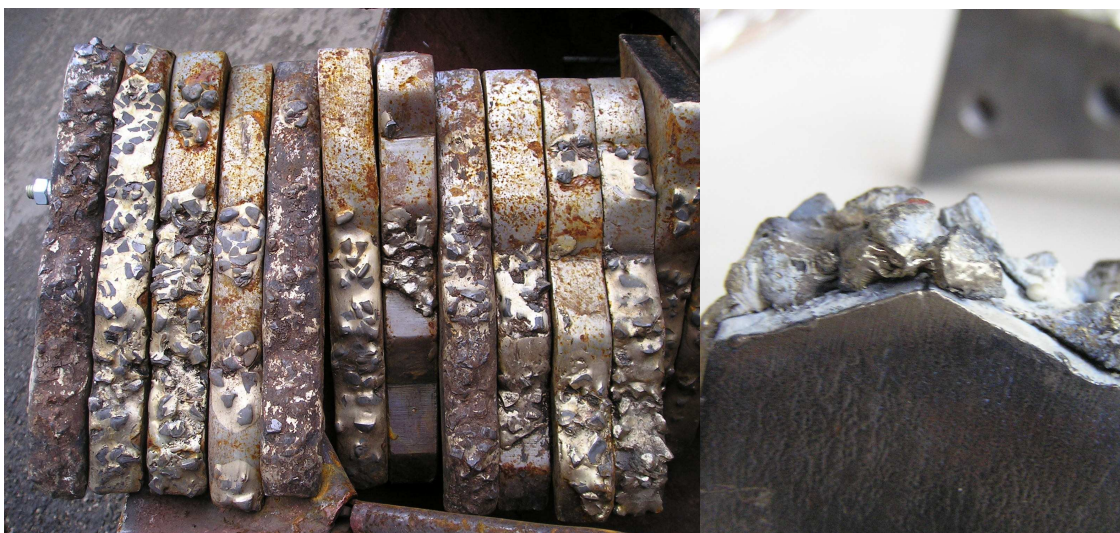
Obr. 5.7 Reklamované kusy, příklad špatně provedeného pájení
