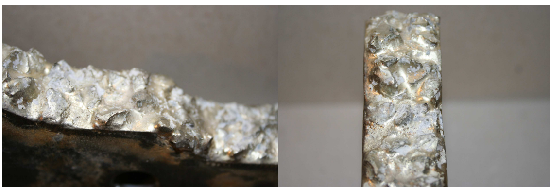
Obr. 4.5 Detail umístění karbidických zrn v nanesené pájce
