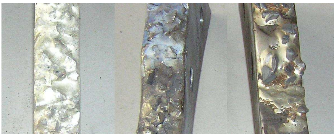
Obr. 5.10 Zleva: Kvalitně vyrobený nůž, chybně vyrobený nůž, opotřebený nůž.
