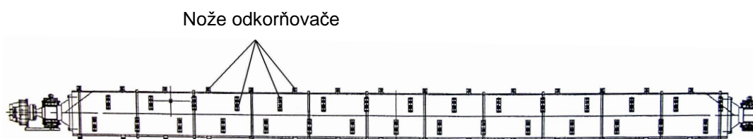
Obr. 4.1. Nože odkorňovače na hlavním rotoru
