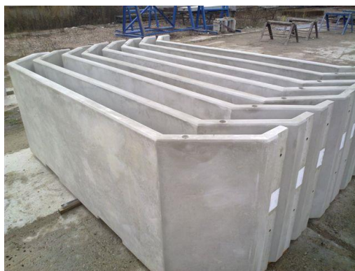
Obrázek 10 Prefabrikované dílce lodžii (interní zdroj)
