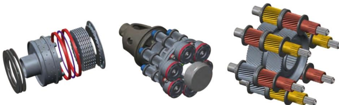
Obr. 10 Vyobrazení jednotlivých komponent systému cTV, vlevo spojka, vpravo hřídele se satelity a centrálními koly, uprostřed kompletní jednotka [42]
