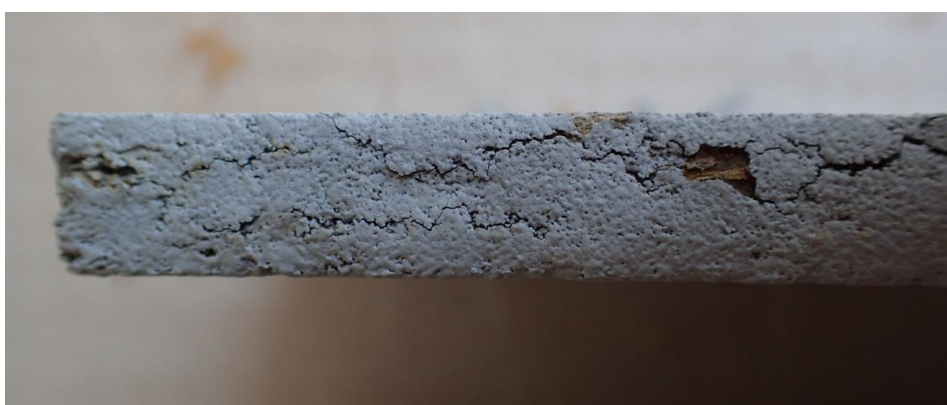
Obrázek 25: Detail hrany vzorku SS4-4 po působení 50 cyklů mrazu v kombinaci chemickými rozmrazovacími látkami
