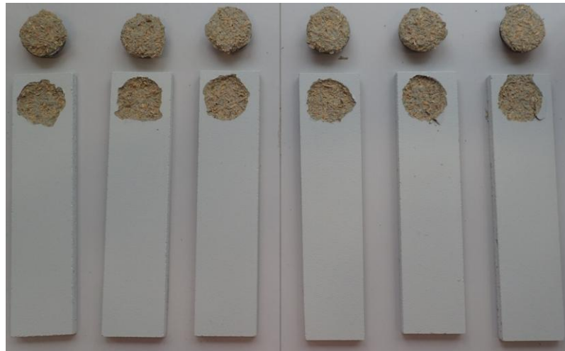
Obrázek 40: Vybraná sada 1SV4 - 6SV4 po C25 a následném odzkoušení odtrhovou zkouškou
