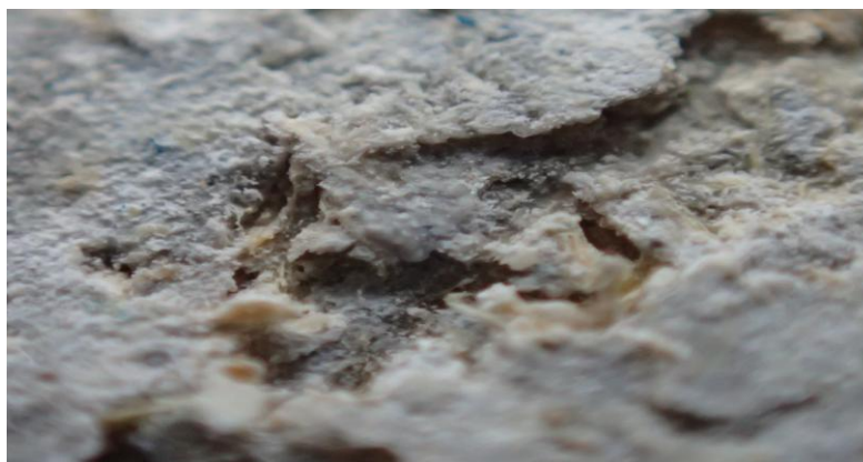
Obrázek 28: Detail průniku síranových solí do matrice cementotřískové desky
