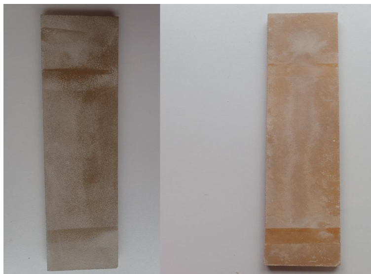
Obrázek 22: Vzorky PI3-1 a PI3-2 po vystavení síranovému prostředí
