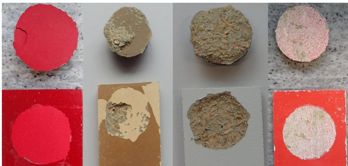
Obrázek 38: Příklady typu porušení při odtrhu terčíku od podkladu
