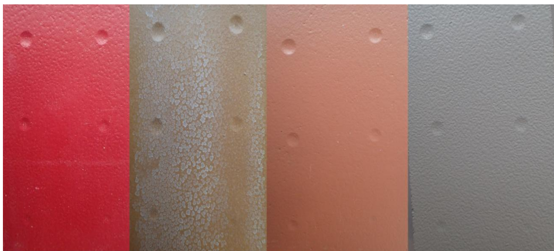
Obrázek 56: Příklady otisku po působení rychlého zatížení
