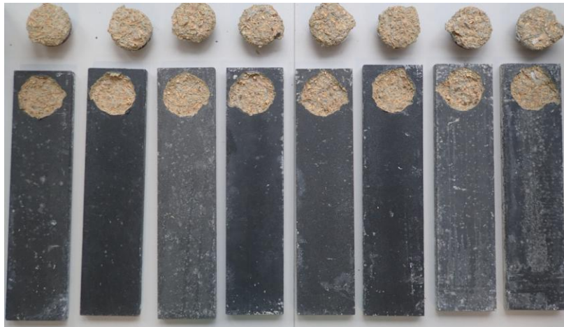
Obrázek 39: Vybraná sada 1TS3 - 8TS3 po S45, odzkoušená odtrhovou zkouškou
