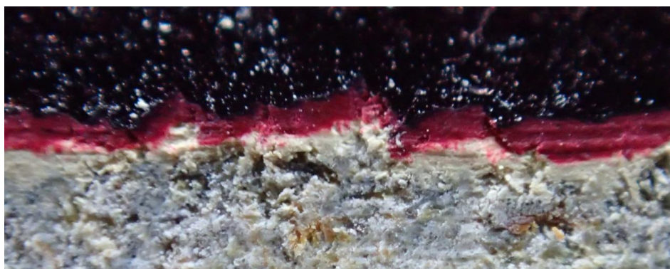
Obrázek 54: Řez nátěrem pro zjištění celkové tloušťky s jasným přechodem mezi základní a finální vrstvou
