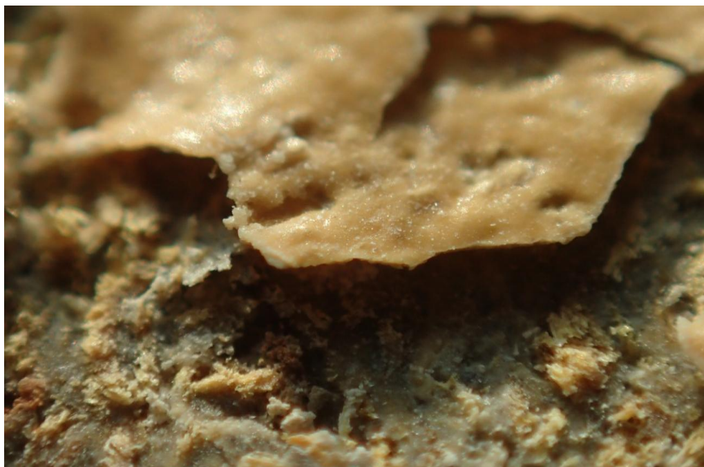
Obrázek 27: Detail porušení lícové strany povrchové úpravy vzorku PI3-1 po působení 50 zmrazovacích cyklů
