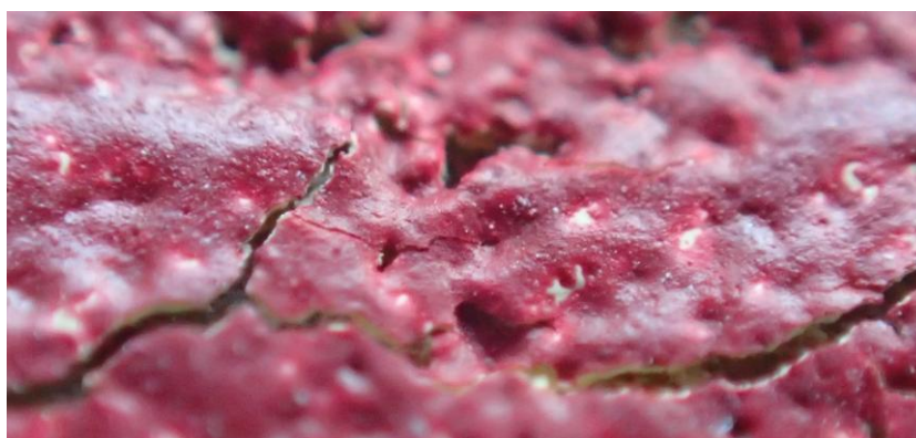
Obrázek 29: Detail trhlinky na boční straně vzorku TC4-3 po působení mrazu
