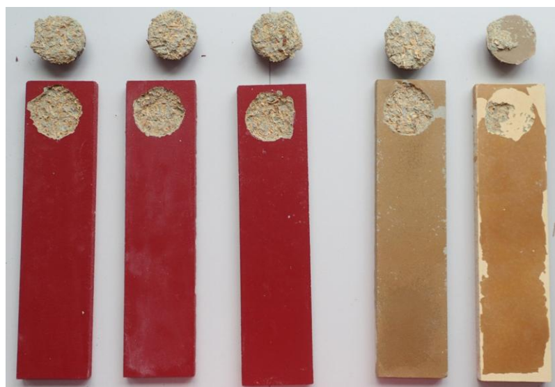
Obrázek 41: Vybraná sada 1P3 - 5TC4 po M50 a následném odzkoušení odtrhovou zkouškou
