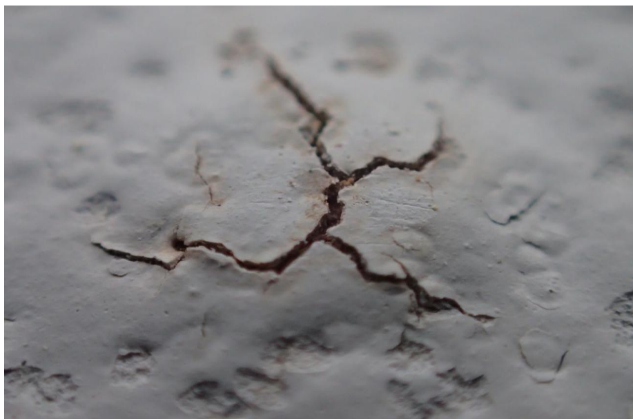
Obrázek 26: Detail trhlinky na lícové straně vzorku SS4-6 po působení 100 cyklů mrazu
