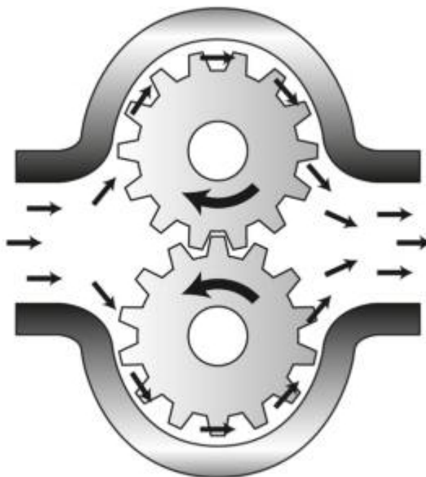
Obr. 9 Princip zubového čerpadla s vnějším ozubením [23]
