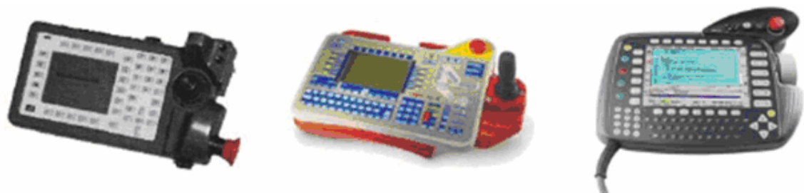
Obr. 14 Příklady druhého typu teach pendantov. Z ľava do prava: ABB, IGM, KUKA, Zdroj: http://www.springerlink.com/content/ac15e5b777e373d5/?p=f36658a6809041c2a4164e096f1ab63a&pi=5
