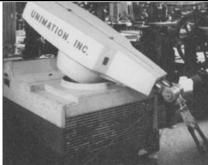
Obr. 2 Prvý prototyp priemyselného robota
