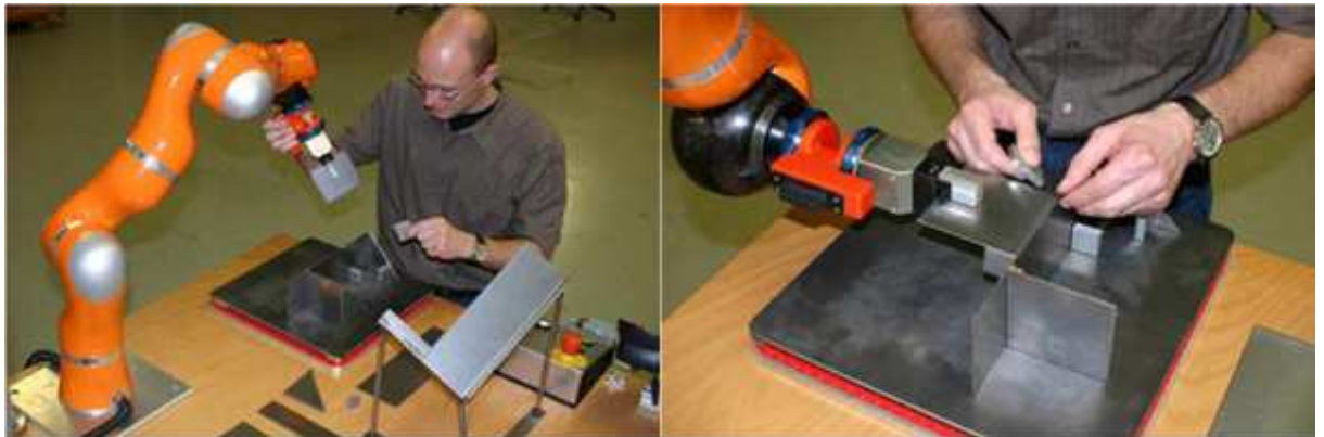
Obr. 24 Pomocná tretia ruka na montážnom pracovisku
