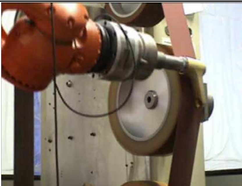
Obr. 26 Brúsenie pomocou silomomentového senzoru.
