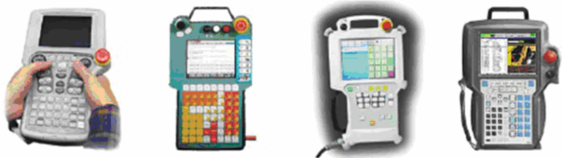
Obr. 13 Příklady prvního typu teach pendantov. Z ľava do prava: Motoman, Reis, Kawasaki, Fanuc. Zdroj: http://www.springerlink.com/content/ac15e5b777e373d5/?p=f36658a6809041c2a4164e096f1ab63a&pi=5
