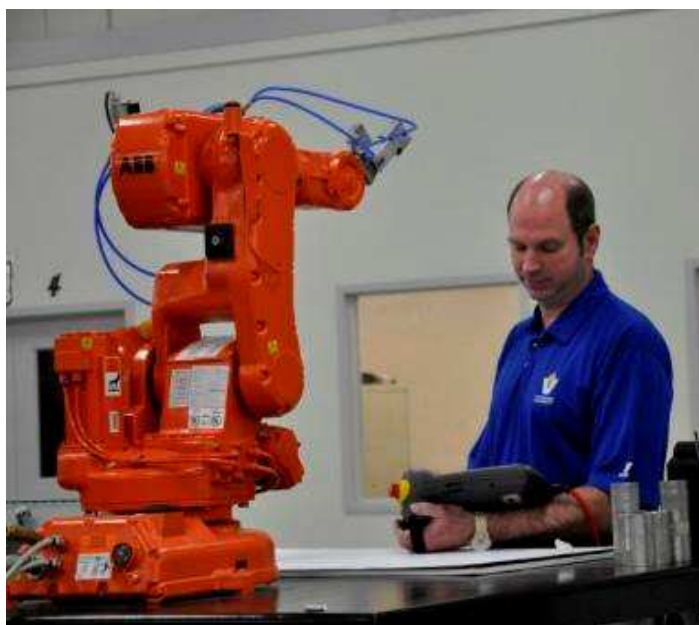
Obr. 17 Metóda Postupného učenia
