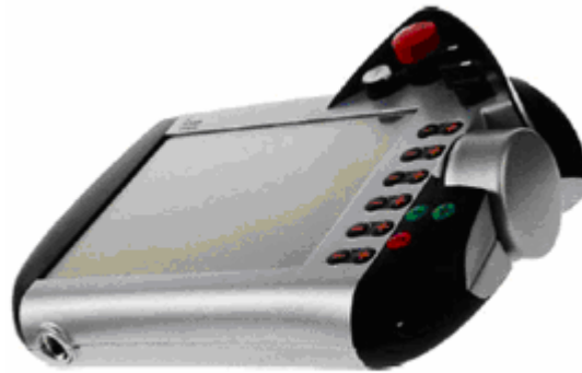
Obr. 15 Prototyp teach pendantu,
