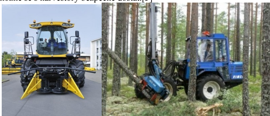
Obr. 2.4 Zleva adaptér New Holland pro sklizeň rrd, Harvestor při práci v lese
