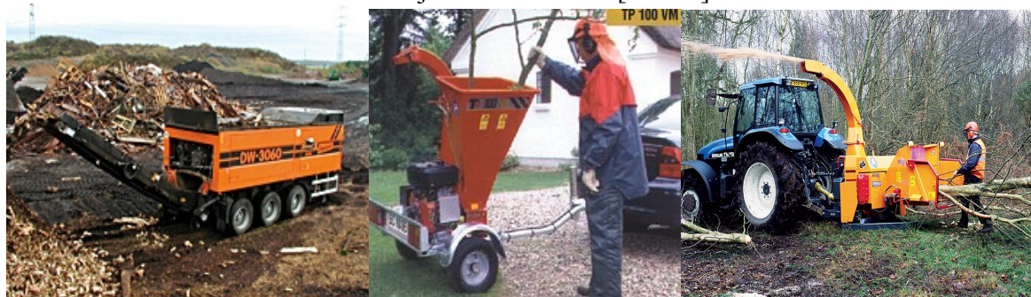
Obr. 2.6 Zleva rychloběžný drtič DW3060, štěpkovač s ručním podáváním za auto, profi štěpkovač Jensen za traktor
