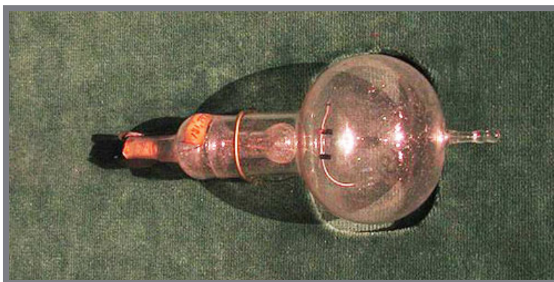
Obr. 2-3 Žiarovka vytvorená spoločnosťou T.A.Edisona [6]
