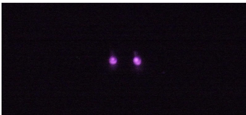
Obr. 3.15: Infračervený zdroj zakrytý křemíkovou deskou.
