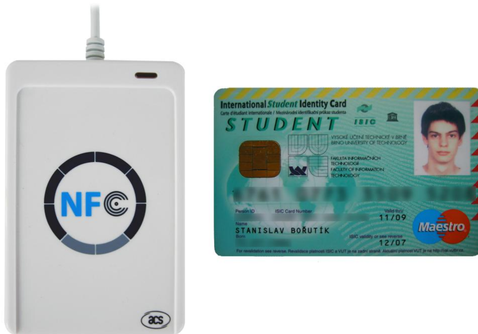
Obrázek 6.4: RFID/NFC čtečka ACS ACR122U ( www.acs.com.hk ) a univerzitní identifikační karta
