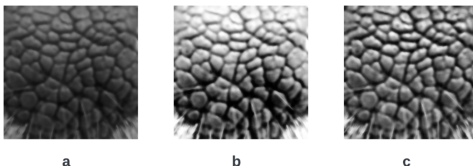
Obrázek 3.20: Aplikace histogramové ekvalizace na obraz. (a) původní obraz, (b) histogramová ekvalizace, (c) CLAHE
