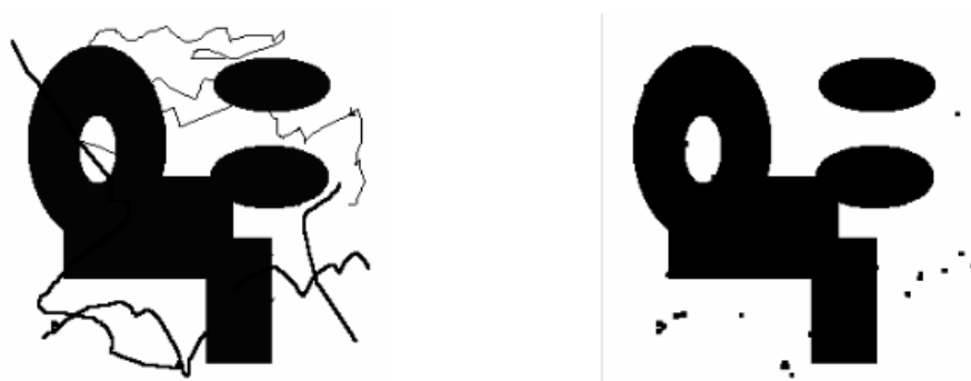
Obrázek 3.11: Aplikace morfologického otevření na vstupní obraz se strukturálním elementem o rozměrech 3x3 [18]
