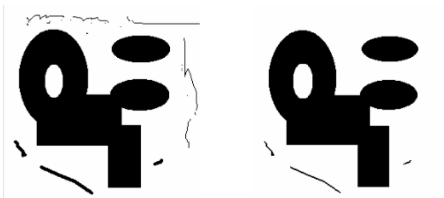
Obrázek 3.10: Aplikace eroze na vstupní obraz se strukturálním elementem o rozměrech 3x3 [18]
