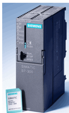
Obrázek 12: PLC Siemens CPU 315-2 DP s přiloženou MMC
