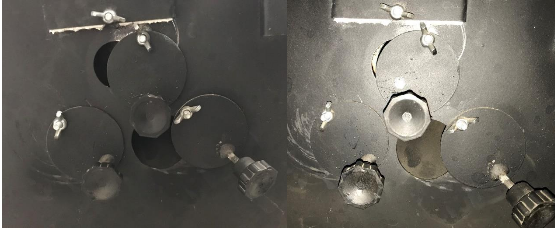
Obrázek 6 - porovnání nastavení přívodu vzduchu pro 1. měření (vlevo) a 2. měření (vpravo)
