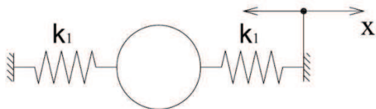
Obr. 40: Tuhosti tenzometrů jsou z hlediska nastaveného posunutí řazeny sériově.
