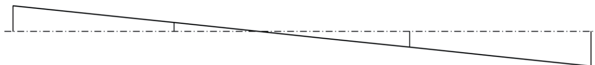
Obr. 37: Tvary kmitu vynuceného kmitání rotoru na otáčkách 1500 ot/min
