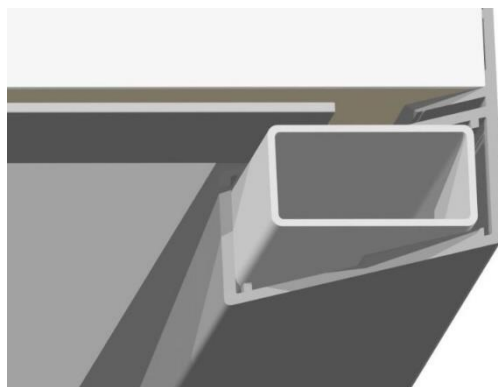
Ocelové profily 60x30x2 (pohled na zadní portál)
