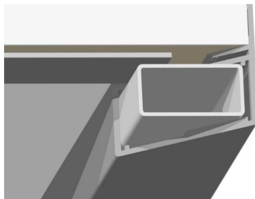
Obr. 52 Ocelové profily 60x30x2 (pohled na zadní portál)
