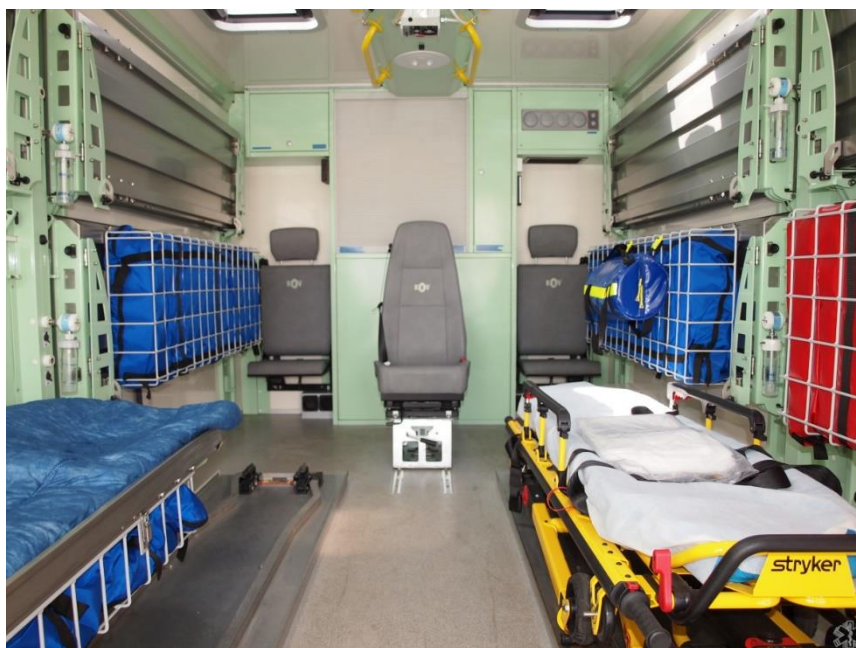
Obr. 14 Interiér nástavby záchrannářského vozu Mercedes-Benz Atego [14]
