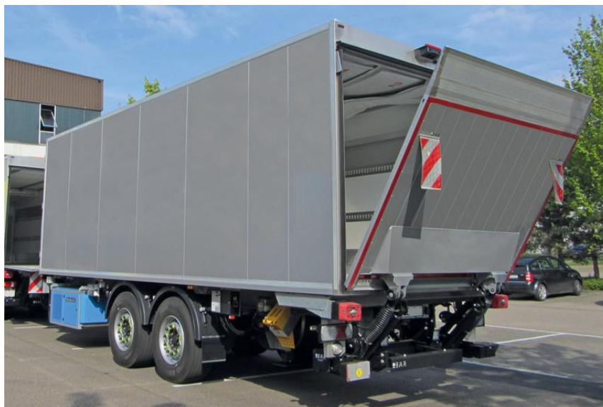
Obr. 64 Zvedací plošina Bär Cargolift BC 1500 S4 [53]
