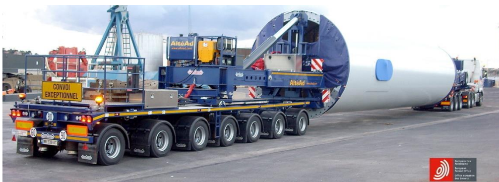
Obr. 3.3 Vežový príves Mega Windmill Transporter [43].
