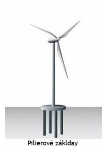
Obr. 2.9 Základné zobrazenie pilierového základu [35].
