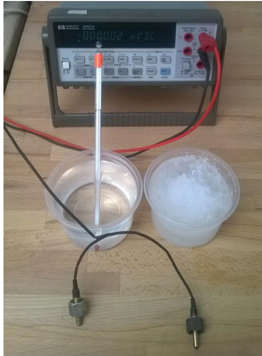
Obr. 13-10 Cejchování termočlánekové sondy
