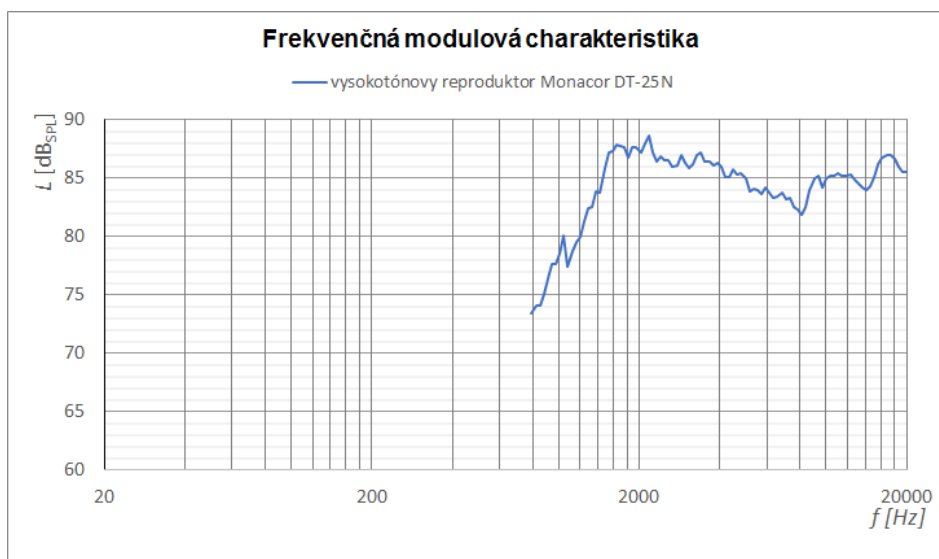
Obr. A.1: Frekvenčná charakteristika vysokotónového reproduktora
