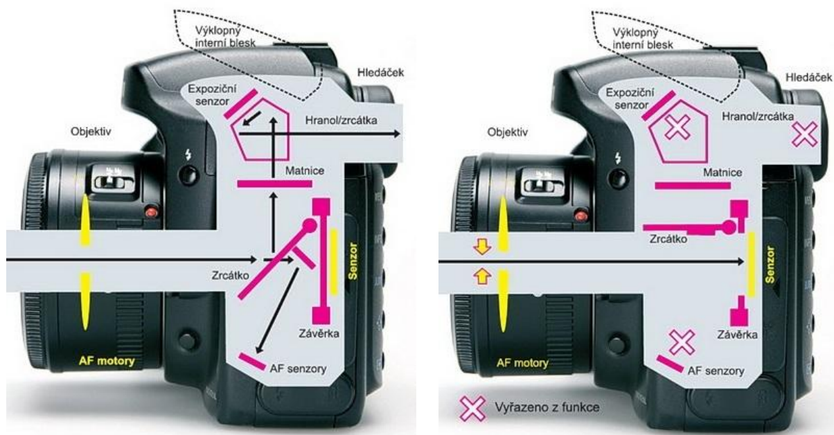
Obrázek 3.6: Konstrukce digitální zrcadlovky
