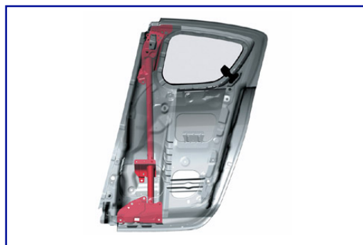
obr. 1.16 Výztuha dveří Mazdy RX-8 [7]
