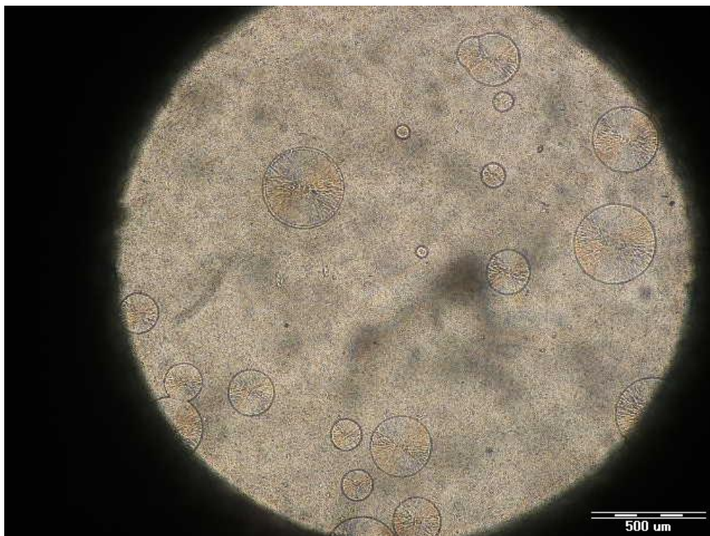
Obrázek 16: Rostoucí sférolity PHB při startu analýzy s NU100 jako nukleantem
