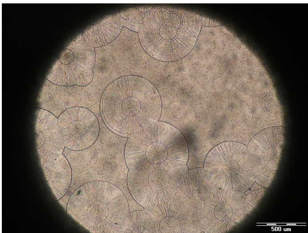
Obrázek 13: Rostoucí sférolity PHB na konci analýzy s ADK NA-11 jako nukleantem
