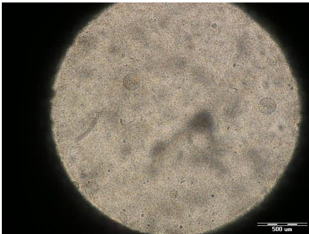
Obrázek 14: Rostoucí sférolity PHB na začátku analýzy s ADK NA-21 jako nukleantem
