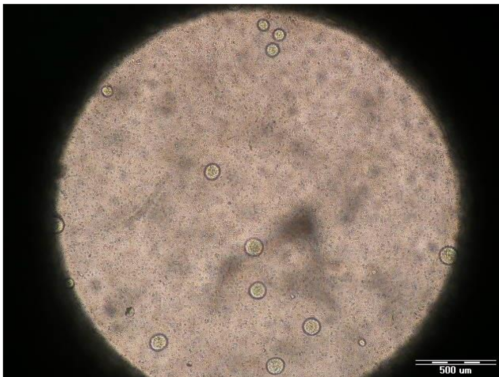
Obrázek 20: Rostoucí sférolity s použitím nitridu boritého jako nukleantu na začátku izotermické krystalizace
