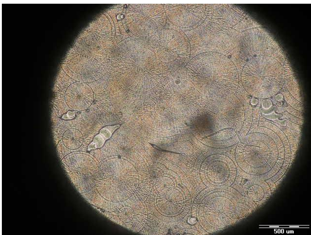
Obrázek 15: Rostoucí sférolity PHB na konci analýzy s ADK NA-21 jako nukleantem
