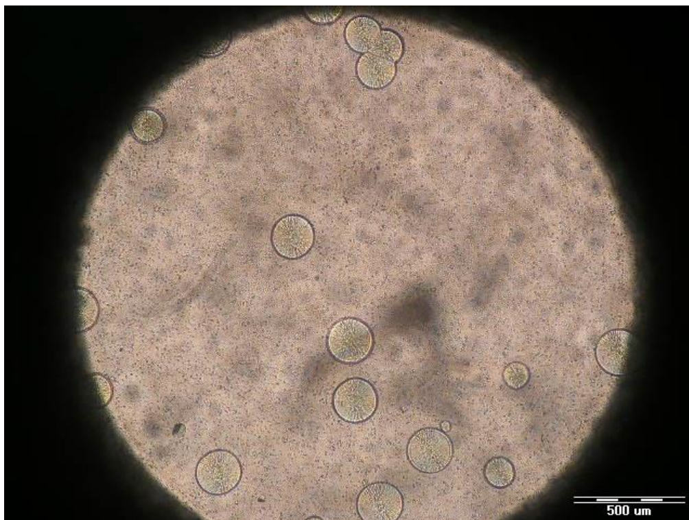
Obrázek 12: Rostoucí sférolity PHB při startu analýzy s ADK NA-11 jako nukleantem
