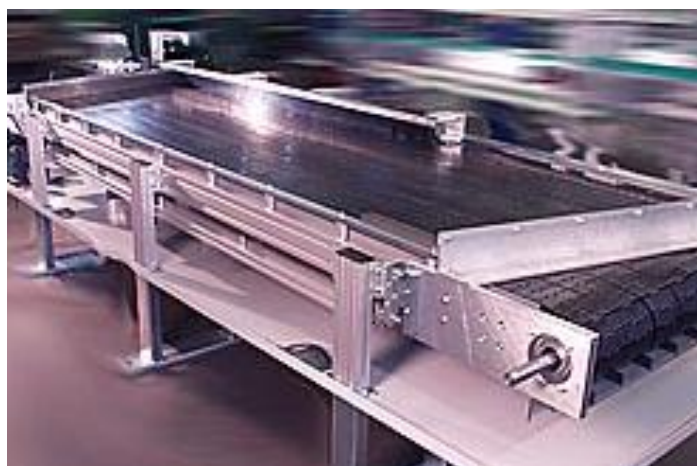
Obr.11 Horizontální řetězový dopravník [9]
