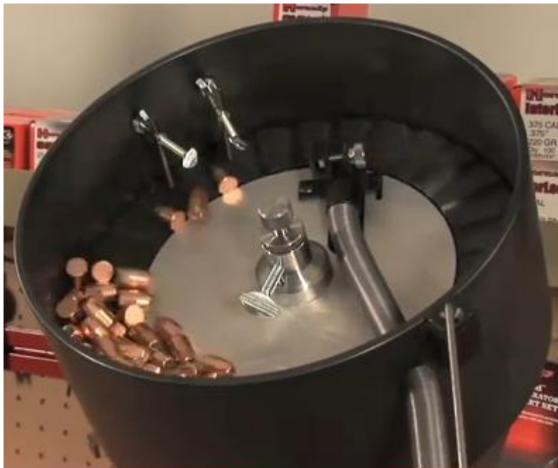
Obr.28 Rotační orientační zařízení pro orientaci střely [18]
