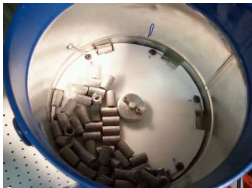
Obr.32 Násypka s kotoučovým orientačním zařízením pro lis Dillon XL 650 [22]
