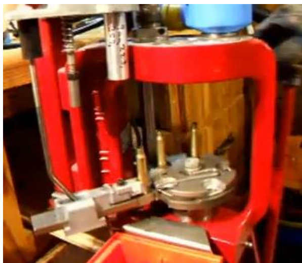
Obr.28 Podávací mechanismus s přímočarým vratným pohybem, mechanismus pro podání nábojnice z trubkového zásobníku do rotačního zásobníku víceoperačního lisu Hornady [10]
