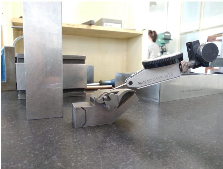
Obr. 18) Měření s upnutím do přípravku
