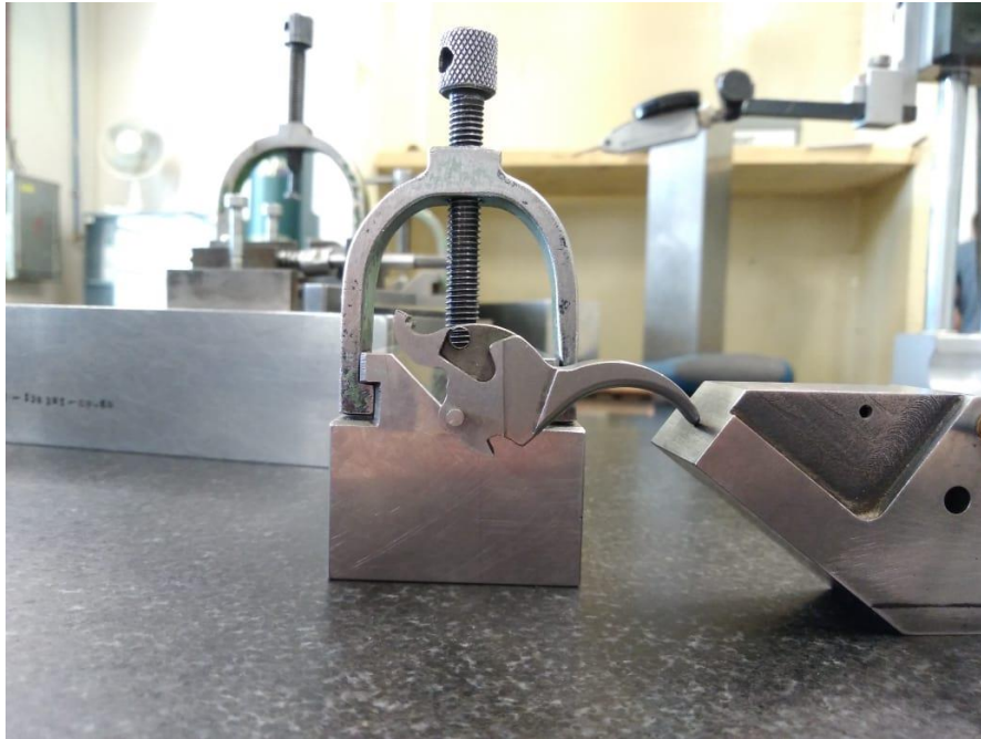
Obr. 17) Měření s upnutím do prizma
