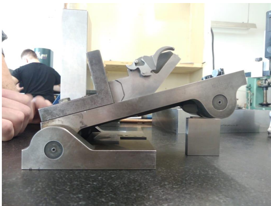
Obr. 20) Použití sinového pravítka
