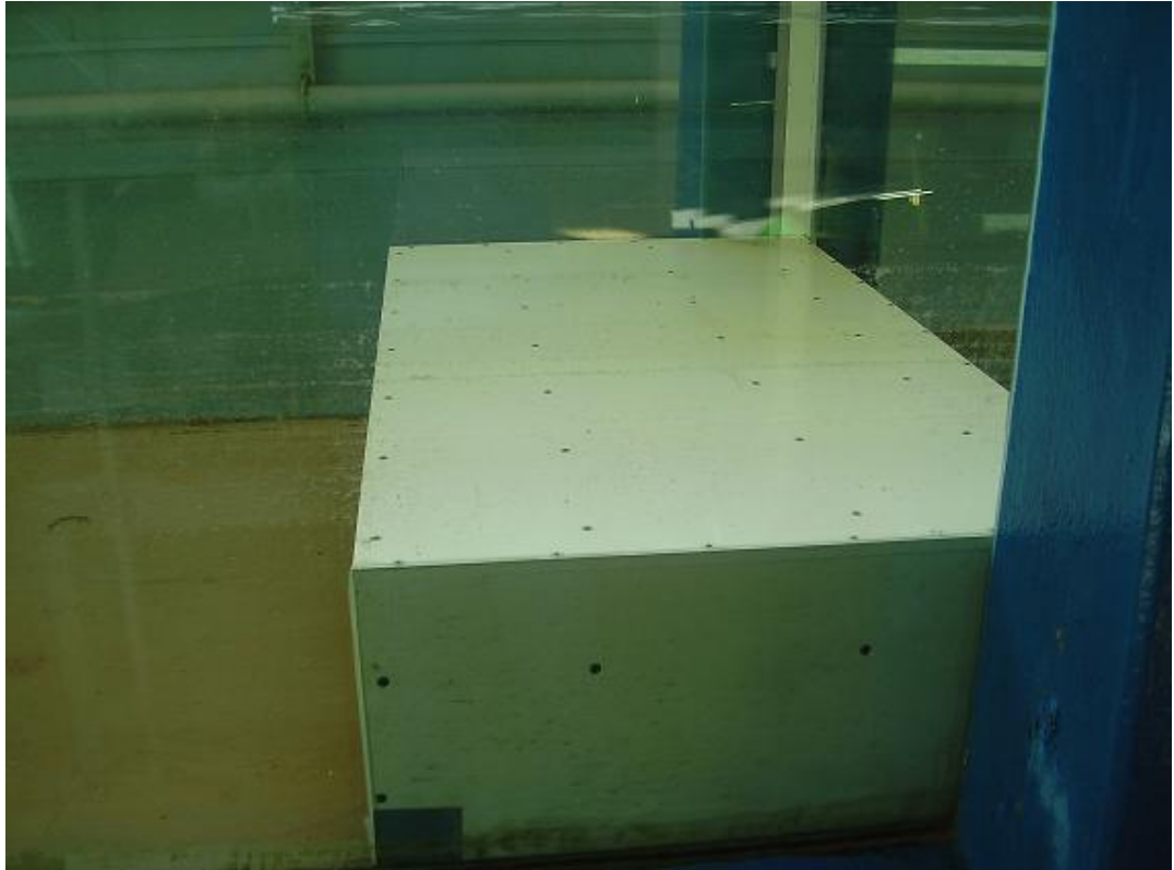
Obr. 6.11 Přeliv se širokou korunou o výšce 0,254 m
