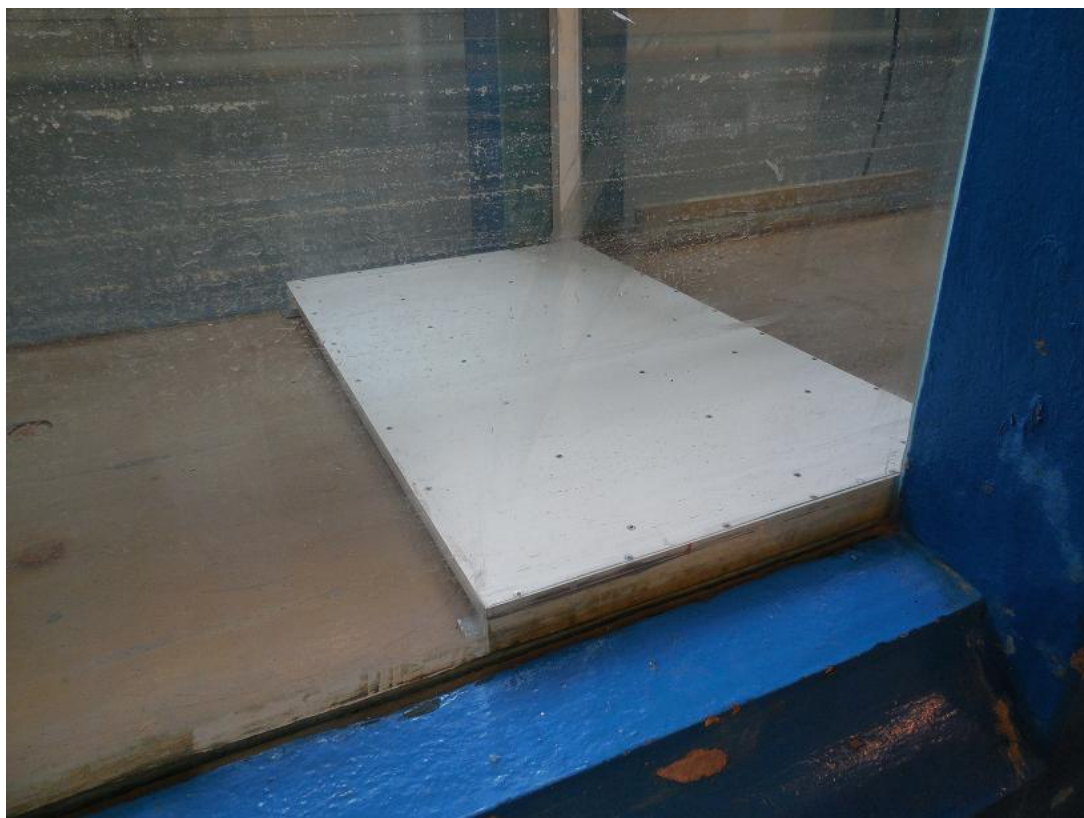
Obr. 6.17 Přeliv se širokou korunou o výšce 0,052 m
