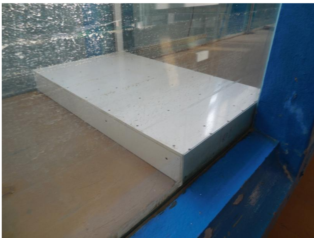
Obr. 6.14 Přeliv se širokou korunou o výšce 0,113 m
