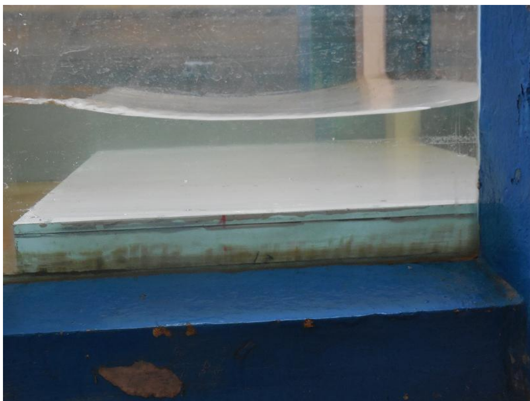
Obr. 6.18 Mezní míra zatopení přelivu se širokou korunou o výšce 0,052 m
