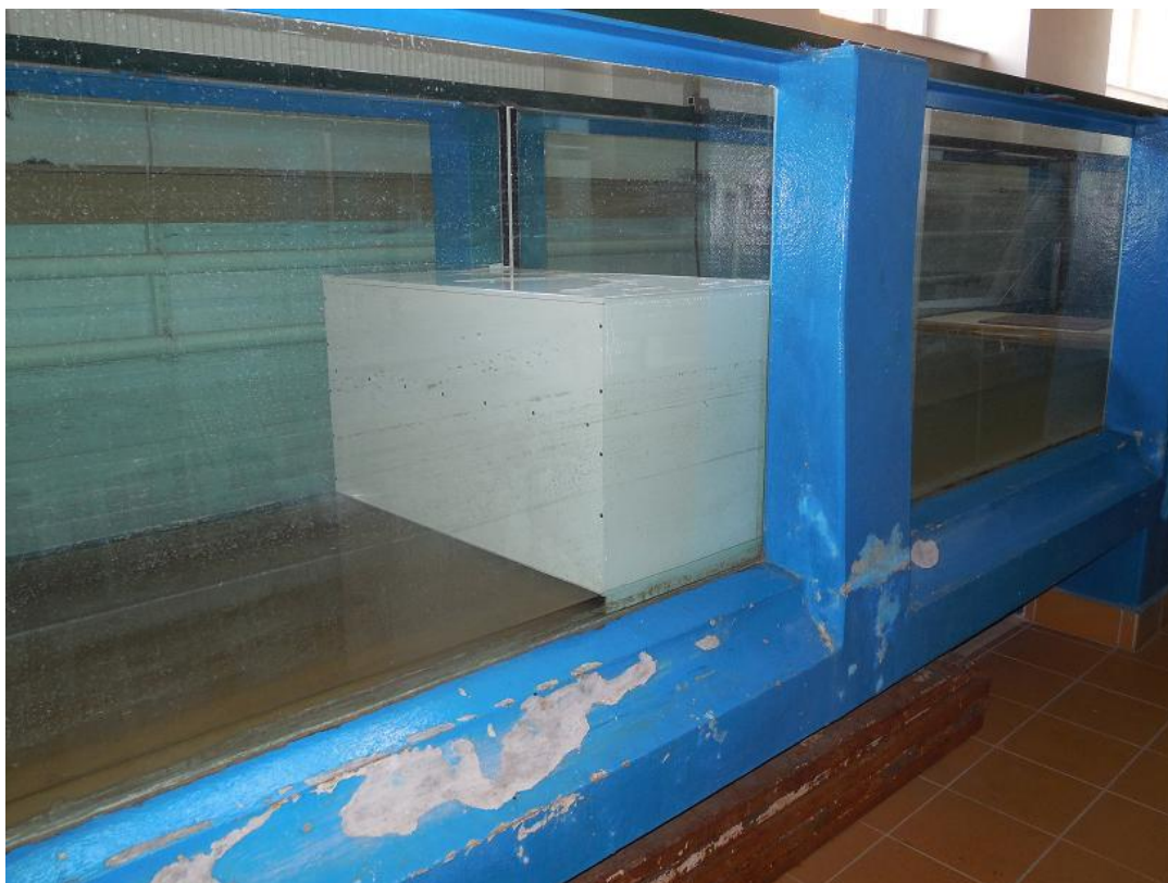
Obr. 6.7 Přeliv se širokou korunou o výšce 0,603 m
