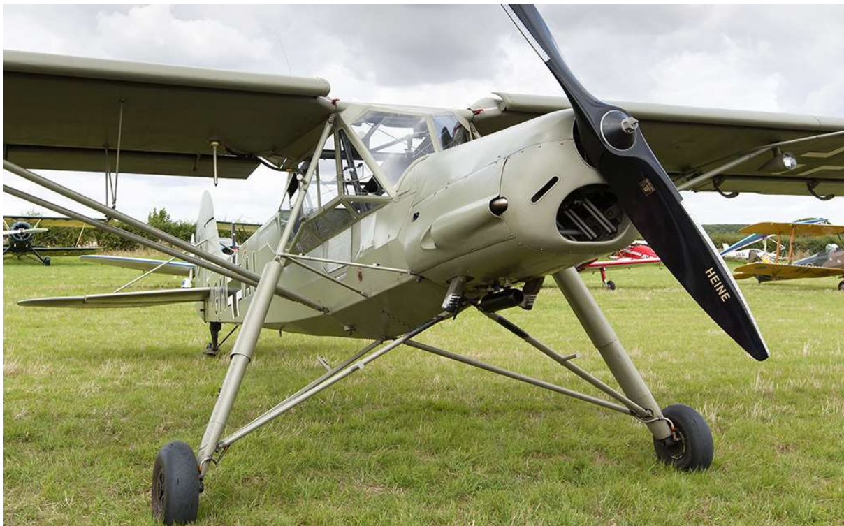
Obrázek 19 Kotvení podvozku do křídla (Fi-156 Storch) [24]
