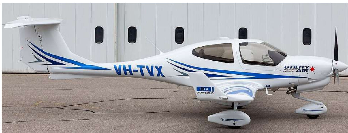
Obrázek 56 Diamond DA40 XLT/NG – zúžení ocasní části trupu [45]
