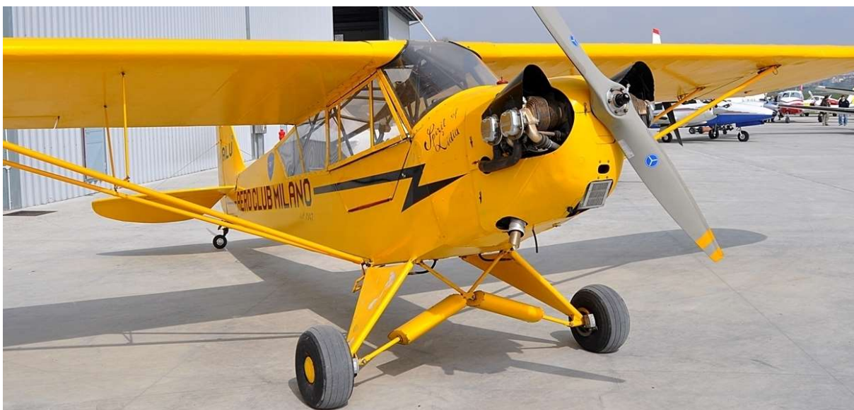
Obrázek 18 Kotvení podvozku do trupu (Piper J-3 Cub) [23]
