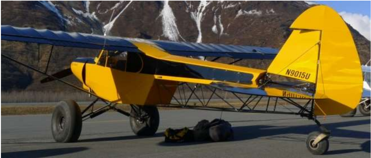
Obrázek 57 Piper Super Cub s odstraněným potahem části trupu [46]
