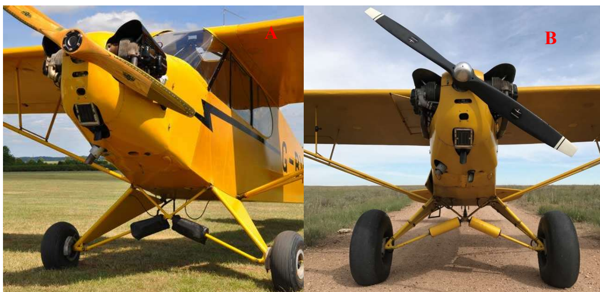
Obrázek 47 Srovnání běžné (A) a Bush pneumatiky (B) [37, 38]
