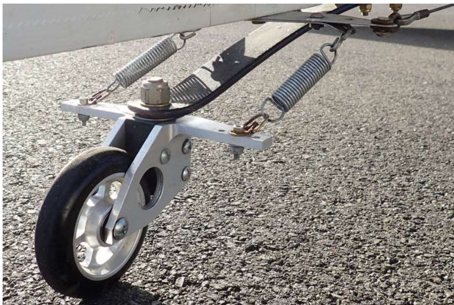
Obrázek 39 Řízení ostruhového kola s tlumícími pružinami [36]
