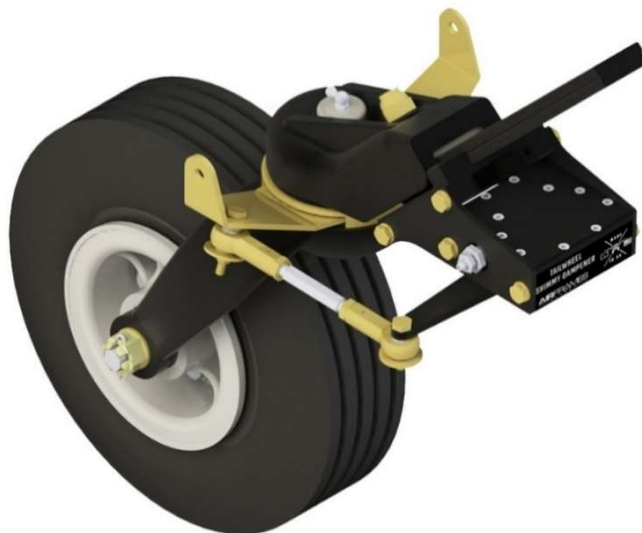
Obrázek 37 Tlumič kmitů ostruhového kola AIRFRAMES ALASKA [34]
