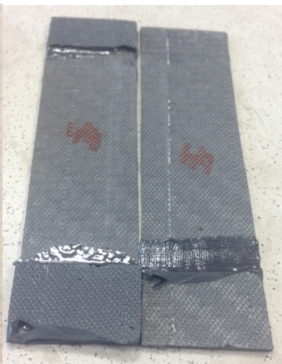
Obrázek 6.11 Adhezivní selhání lepidla DP 490
