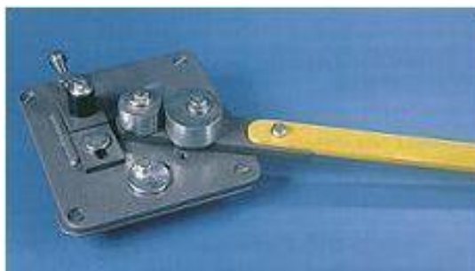
Obrázek 56: Ruční ohýbačka stavební oceli ST 1235
