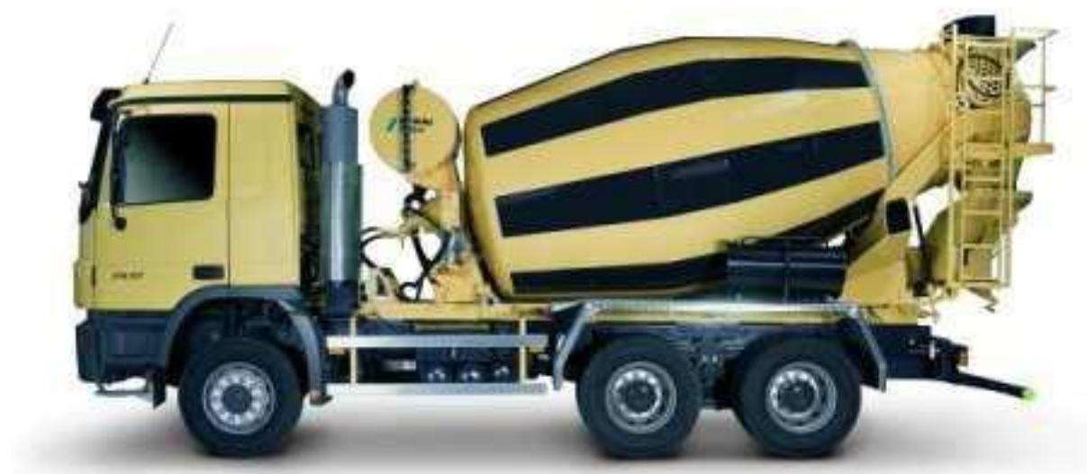
Obrázek 40: Autodomíchávač Stetter AM 8 C na podvozku MAN TGM 26.340
