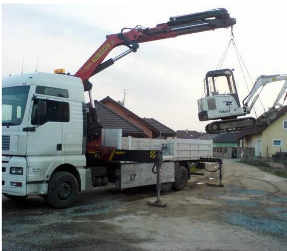
Obrázek 44: Valník MAN TGA na podvozku 26.460 s HR Palfinger
