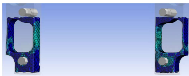
Obr. 45 Vybraný objem insertu pro analýzu napětí
