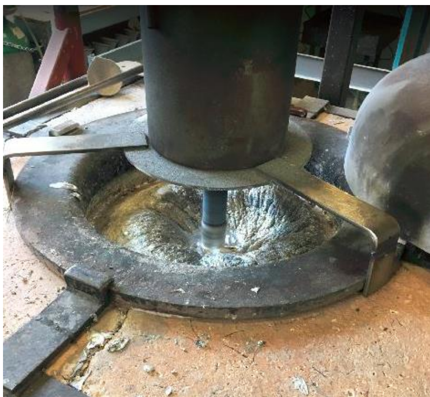
Obr. 26 Odplyňování taveniny dmýcháním argonu
