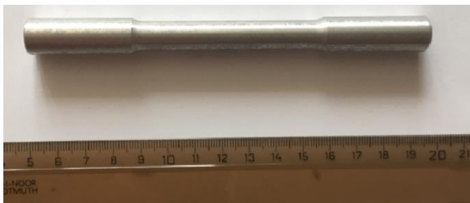
Obr. 28 Výkres [21] a fotografie obrobené tyčinky pro zkoušku tahem
