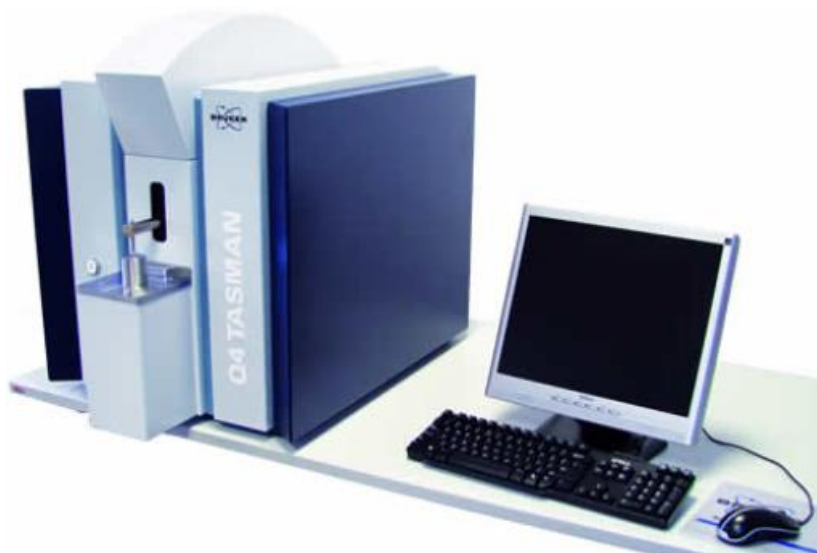
Obr. 31 Jiskrový spektrometr Q4 TASMÁN [23]
