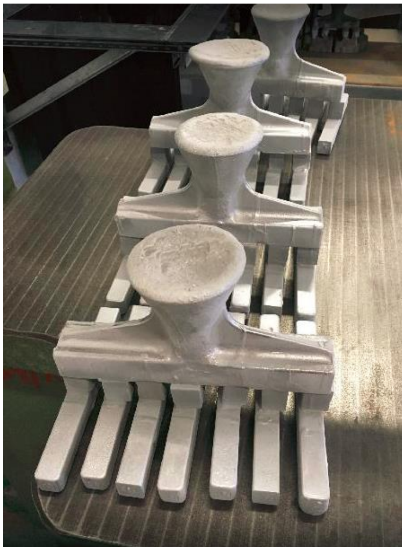
Obr. 27 Odlité zkušební tyčinky
