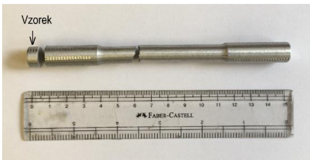
Obr. 32 Uřezaný vzorek na metalografický výbrus
