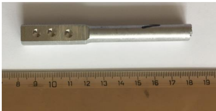
Obr. 30 Vzorek po měření tvrdosti
