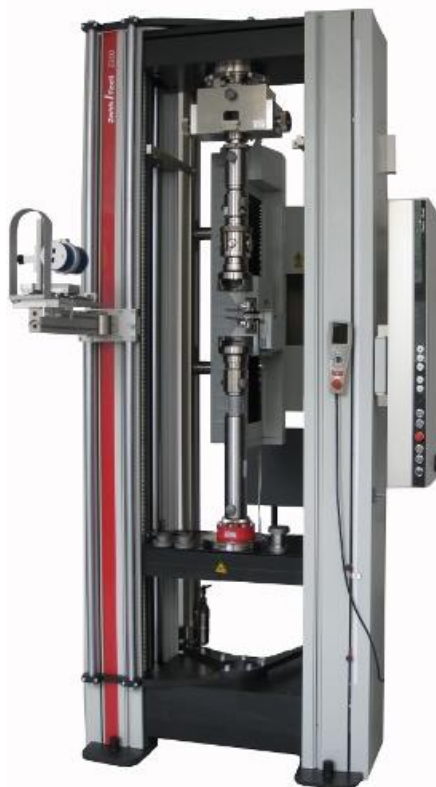
Obr. 29 Univerzální trhací stroj ZWICK Z250 Allround-Line [22]
