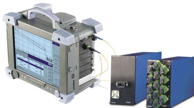
Obr. č. 7: FTB-400 s optickými přepínači FTB-9100
