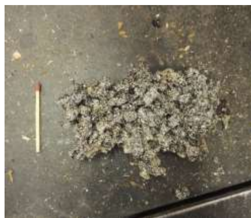
Obr.3.12 Spečené zbytky pelet, velikostní sronání
