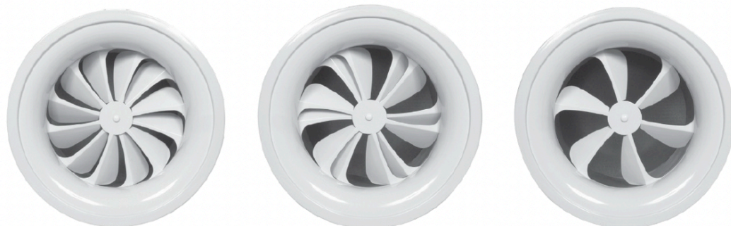
Obrázok 9 - natočenie lopatiek a) horizontálny smer - chladenie b) 45° smer - izotermný c) vertikálny smer – vykurovanie [19]
