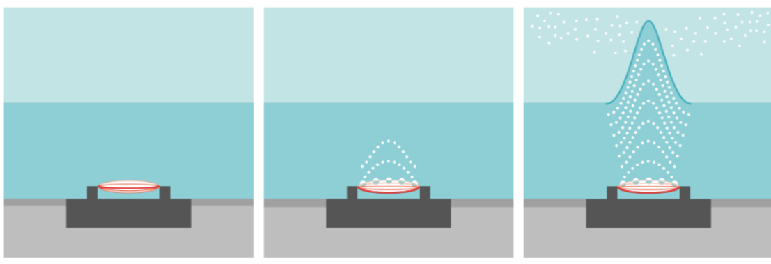
Obrázek 5.1 Princip vyvíjení vodní páry pomocí piezoměniče [9]
