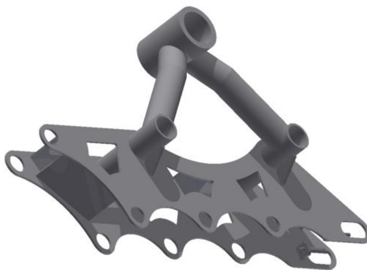
Obr. 23 Zvarenc rÁmu a napinÁkom
