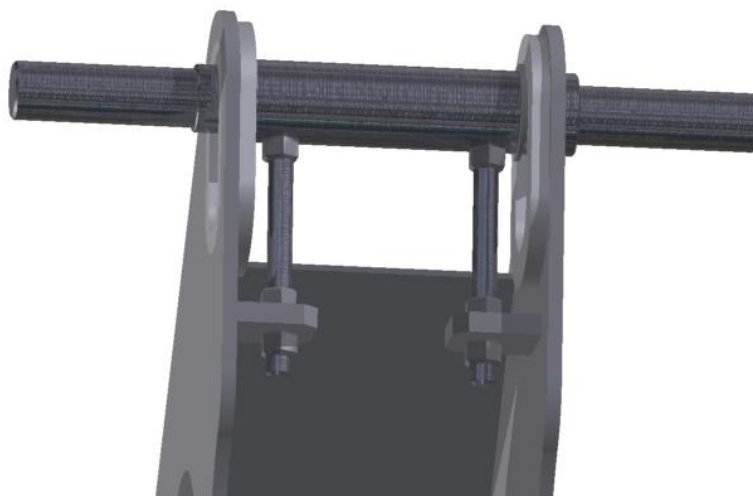
Obr.27 Detail napínacieho zariadenia
