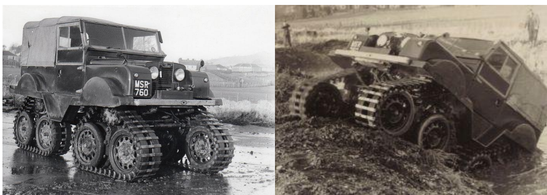
Obr. 8 Land-Rover S1 s pásovým podvozkom James A. Cuthbertson a) na ceste, b) v náročnom teréne [15]
