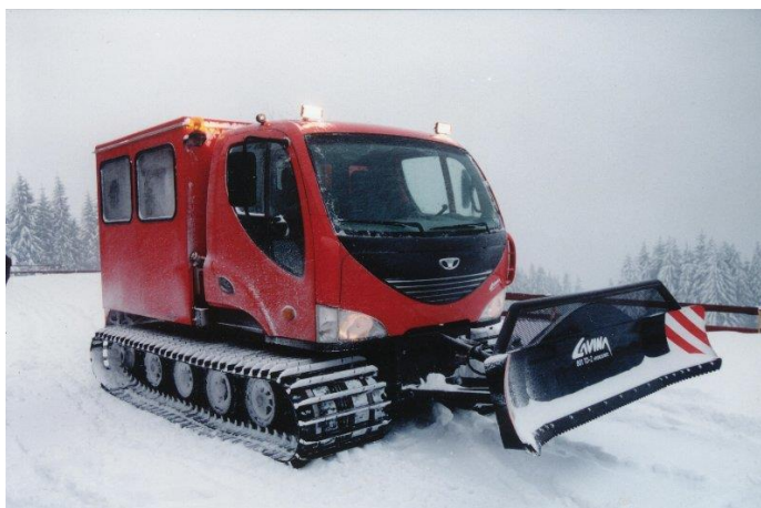
Obr.1 Rolba Lavína 801TD-Z so sklopnou radlicou[4]
