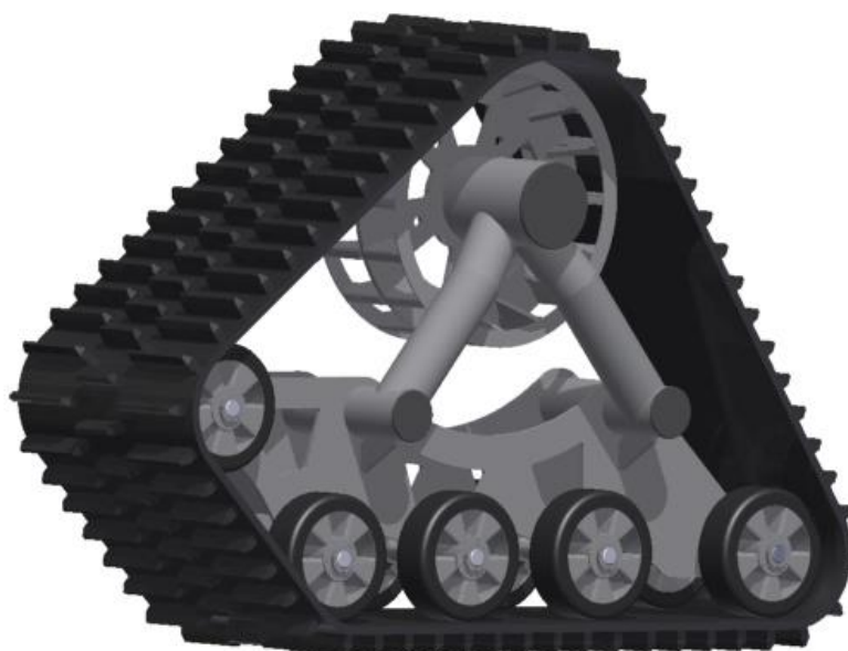
Obr. 28 Zostava modulu pásového podvozku
