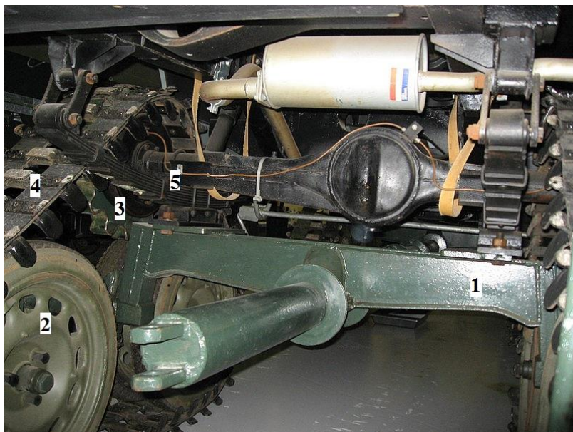
1. pomocný rám, 2. oceľový disk s pneumatikou, 3. hnacie ozubené koleso, 4. pás, 5. náprava automobilu Land-Rover S1 prichytená k podporného rámu pod listové perá
