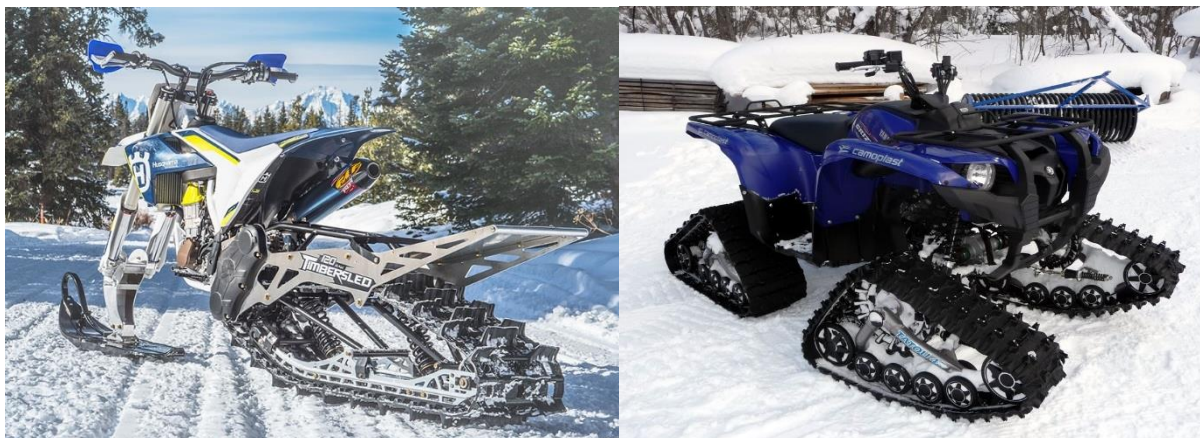
Vľavo: Set pásového podvozku a prednej lyže pre motocykel od fy. Timbersled Vpravo: Štvorkolka Yamaha Grizzly s pásovým podvozkom Tatoo 4S
