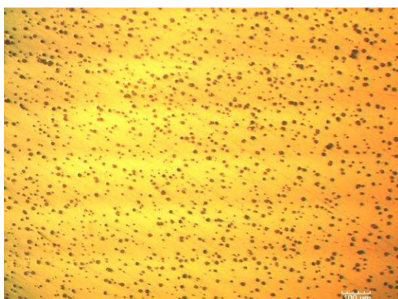
Obr. 48 Struktura litiny s kuličkovým grafitem pro variantu III/1: a) neleptaný stav, b) leptaný stav.
