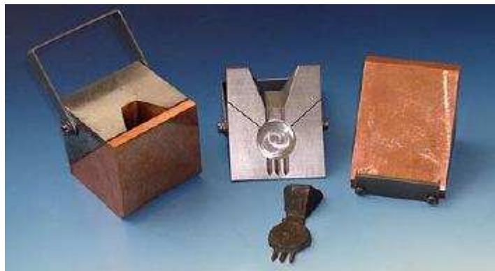
Obr. 11 Měděná kokila na výrobu vzorku pro kontrolu chemického složení. [8]
