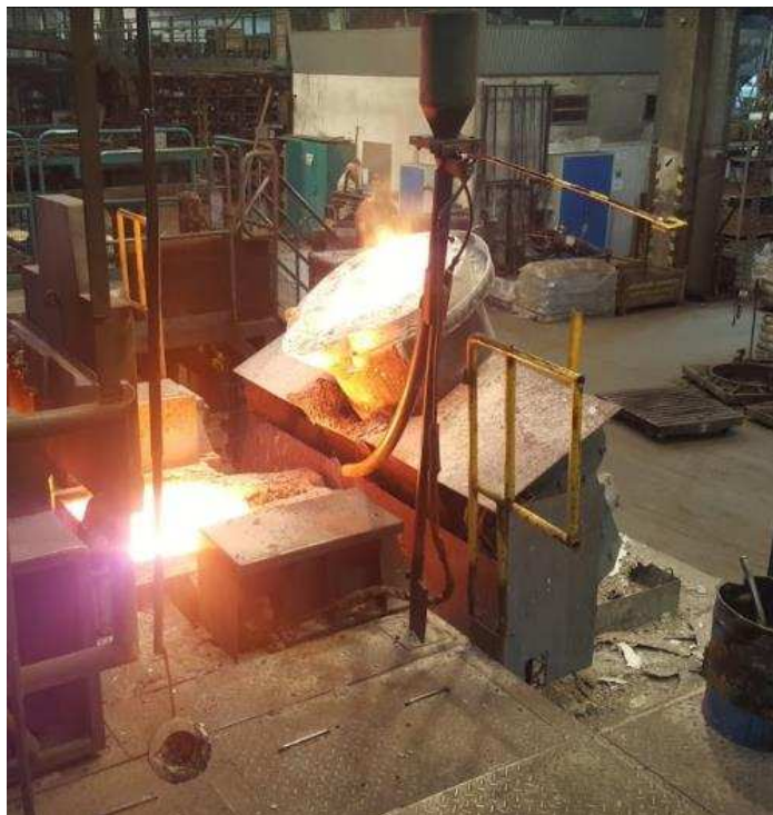
Obr. 24 Zařízení pro aplikaci očkovačla v první fázi.
