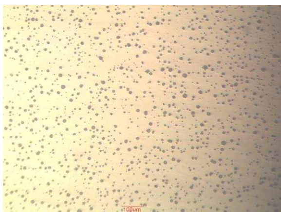
Obr. 38 Struktura litiny s kuličkovým grafitem pro variantu II/1: a) neleptaný stav, b) leptaný stav.
