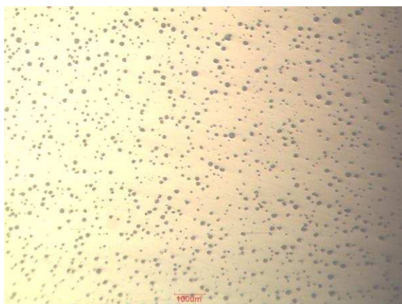
Obr. 39 Struktura litiny s kuličkovým grafitem pro variantu II/2: a) neleptaný stav, b) leptaný stav.
