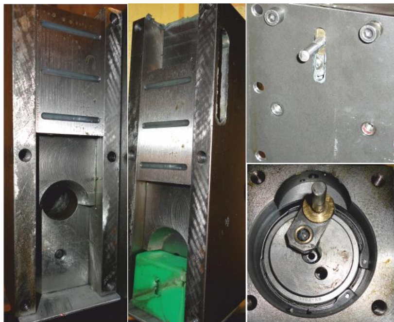
Obr. 11.4 - Střihací nůž a převod rotačního pohybu na lineární
