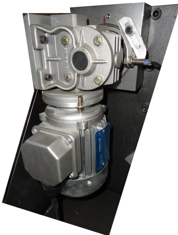
Obr. 11.3 - Motor střihu se šnekovou převodovkou a indukčním čidlem koncové polohy
