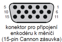
Obr. 7.5- Zapojení pinů pro připojení enkodéru [5]
