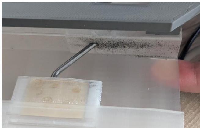
Obr. 40 Finální trhlina Model 2 - primární
