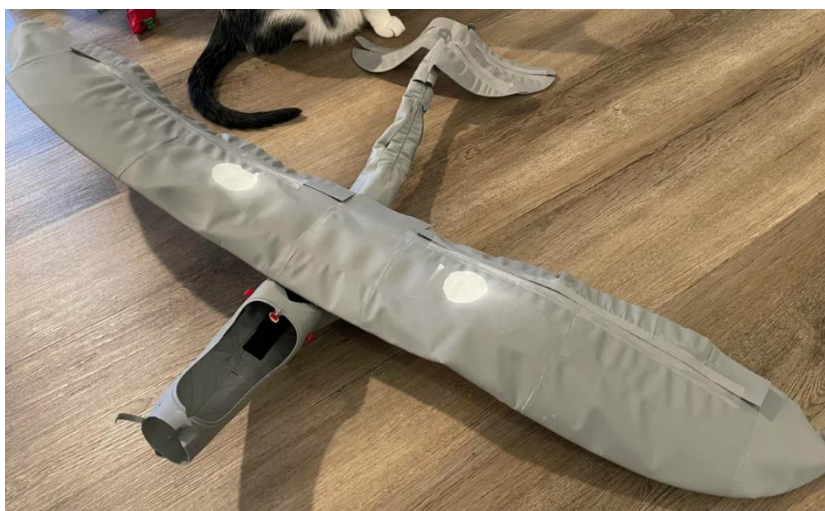
Obr. 10 RC letoun z LW PLA deformovaný po zahřátí v automobilu [19]
