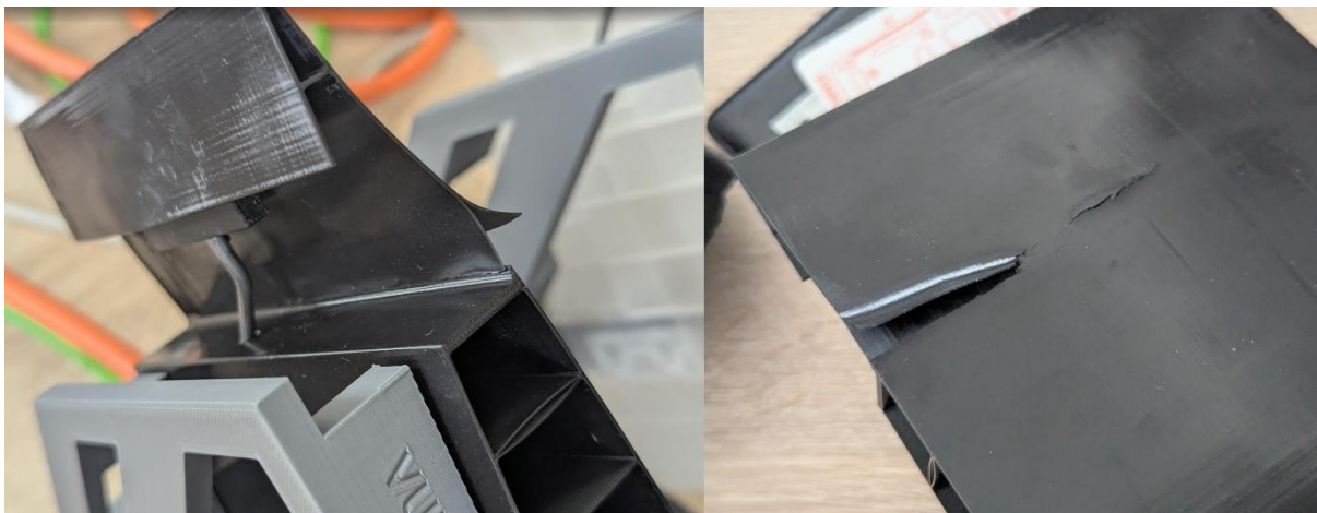
Obr. 41 Finální delaminace, trhliny Model 2 – terciální
