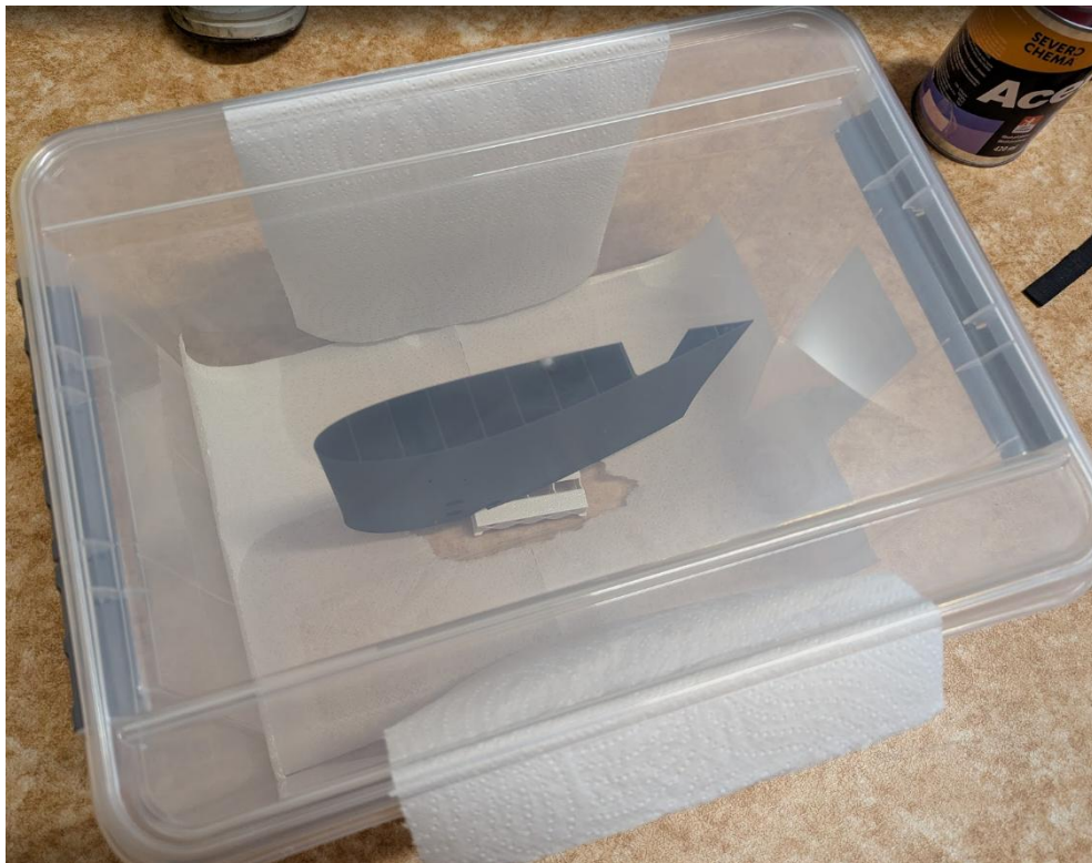
Obr. 34 Proces leptání ASA modelu 2 acetonem
