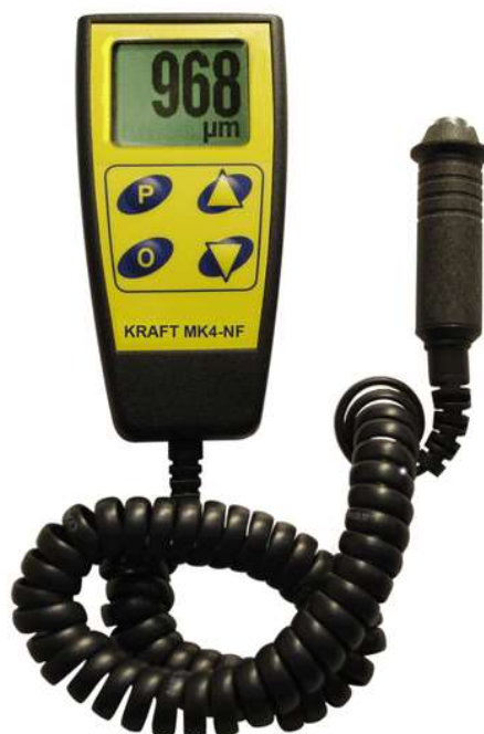
Obr. 4.7 Přístroj k měření tloušťky povrchové vrstvy metodou magneticko induktivní [8]
