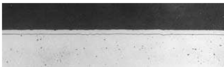
Obr. 4.2 Přechod ocel-zinek při galvanickém pokovení [29]
