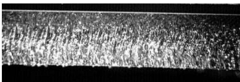
Obr. 2.10 Charakteristická řezná plocha při dělení laserem [32]
