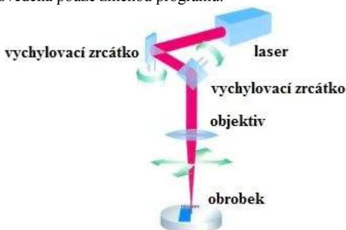
Obr. 2.17 Princip laserového popisování [33]
