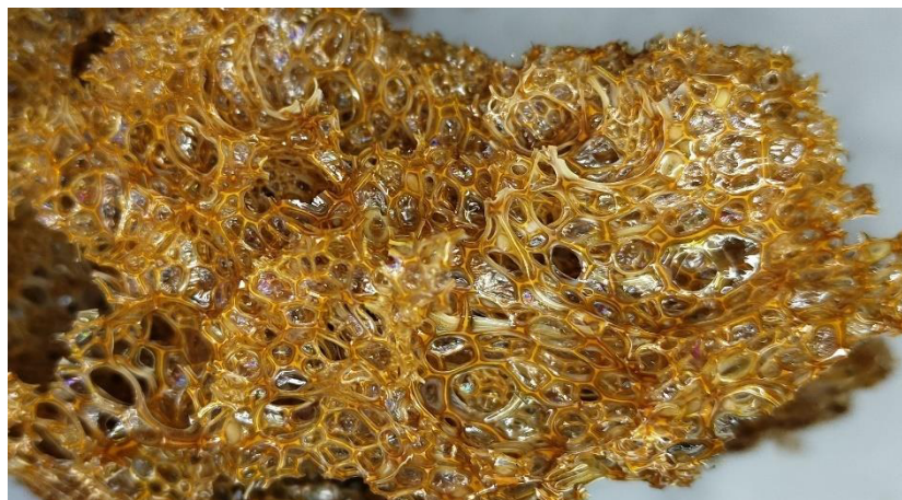
Obr. 5: struktura vysušeného gelu.
