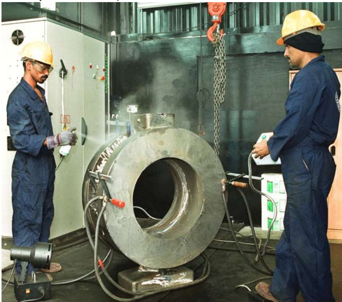
Obr.2.1.7: Magnetování odlitku průchodem proudu pomocí elektrod [9]
