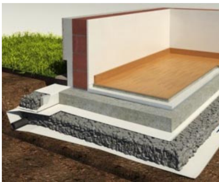
Obr. 15 Založení na základové desce izolované drtí z pěnoskla
