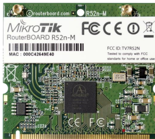
Obrázek 6: Radiová MIMO karta Mikrotik
