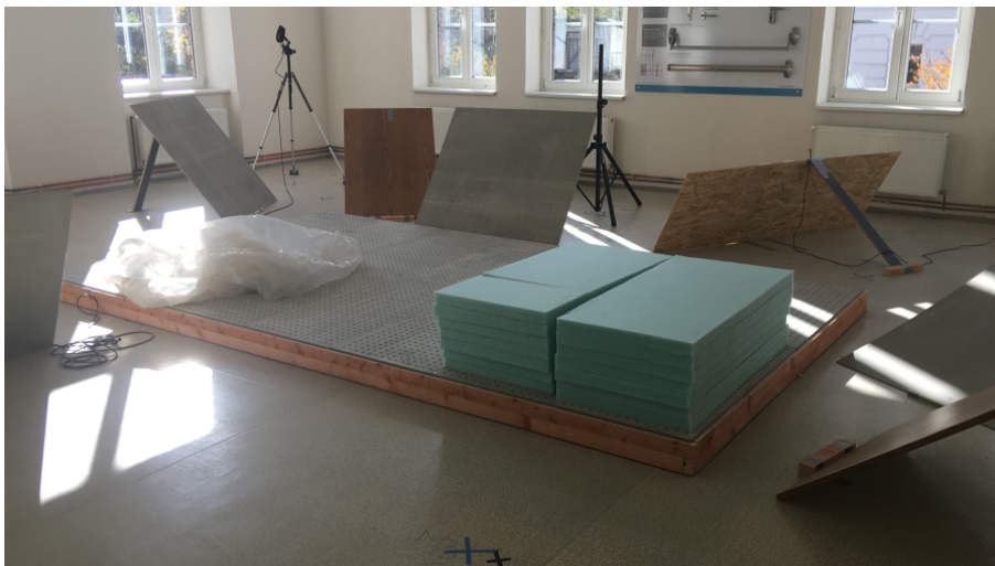
Obr. B.22: Desky izolantu připravené pro vložení do rámu. [autor]
