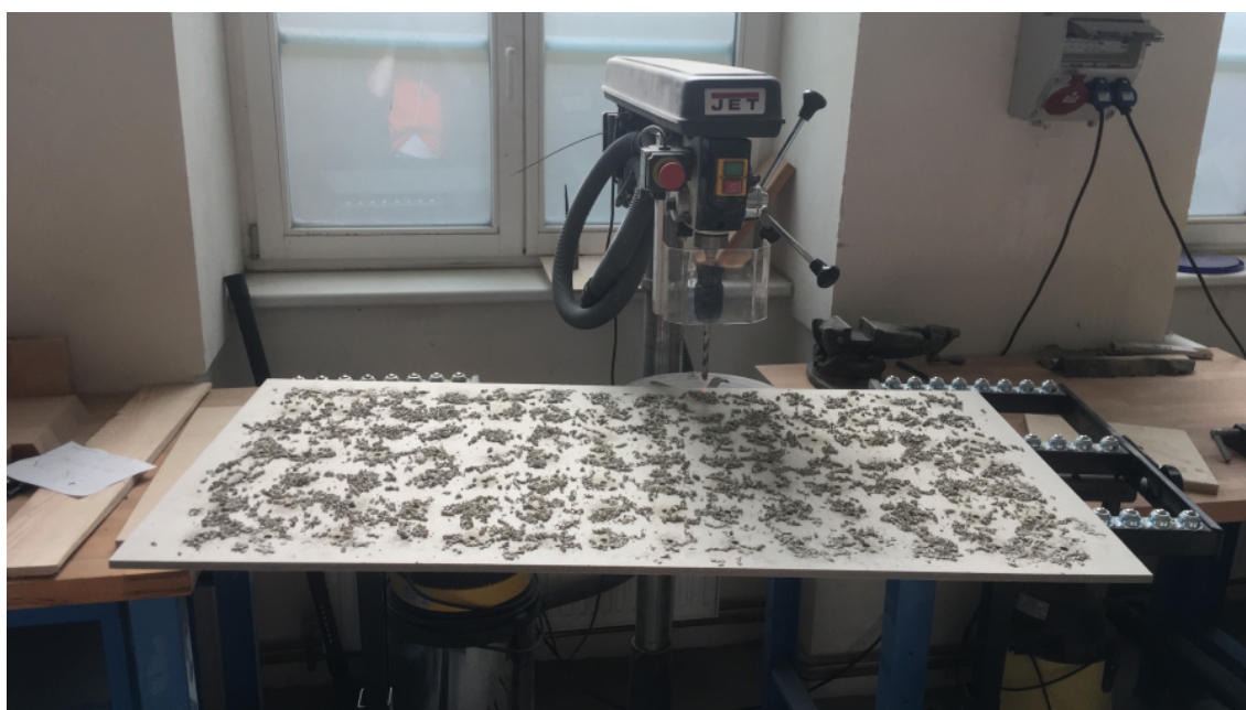
Obr. B.17: Vrtání děrovaných desek. [autor]
