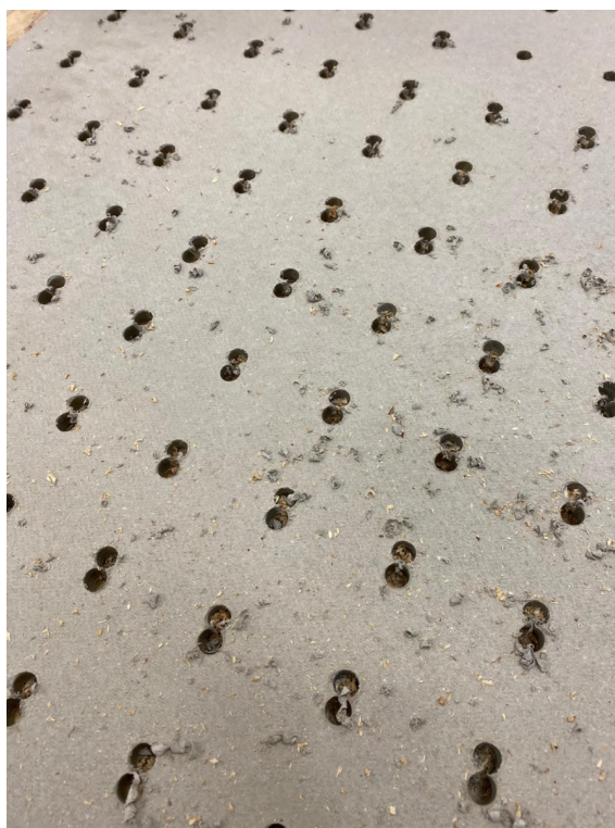
Obr. B.19: Děrování desky před profrézováním. [autor]
