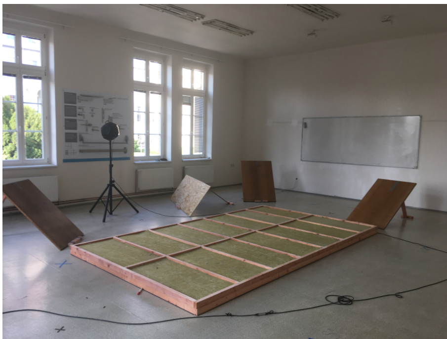
Obr. B.13: Umístění prvních odrazných desek. [autor]
