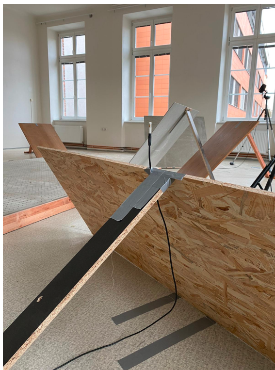
Obr. B.24: Umístění čidla pro měření teploty vzduchu a relativní vlhkosti. [autor]
