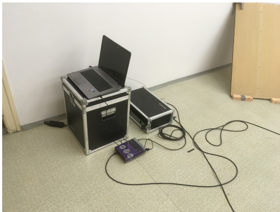
Obr. B.25: Měřicí sestava - notebook, zvuková karta a výkonový zesilovač. [autor]
