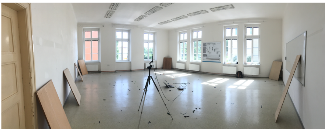
Obr. B.9: Úvodní měření dozvuku pomocí balónů. [autor]
