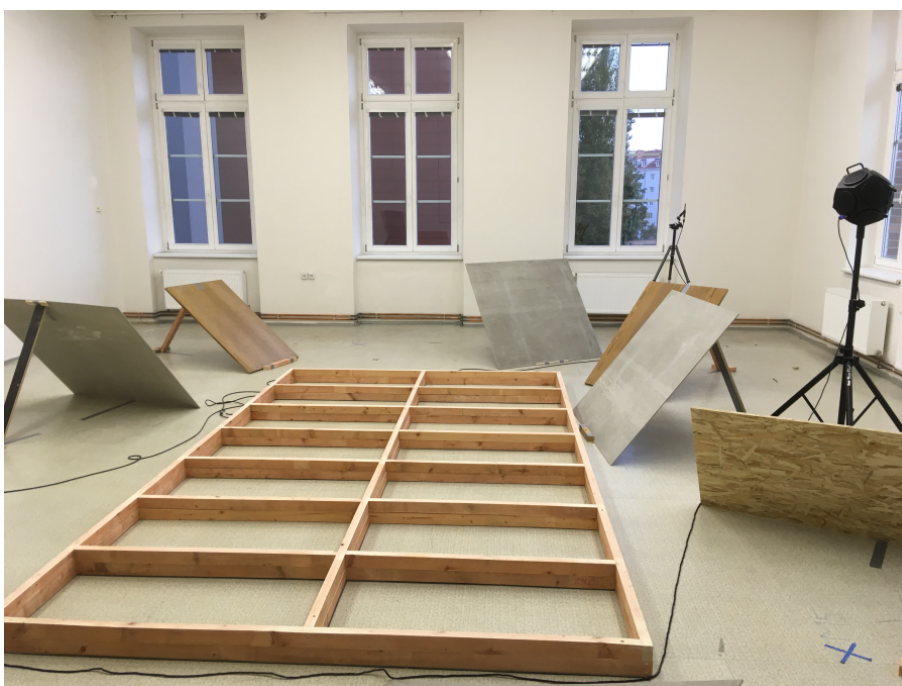
Obr. B.15: Měření reference za přítomnosti rámu. [autor]
