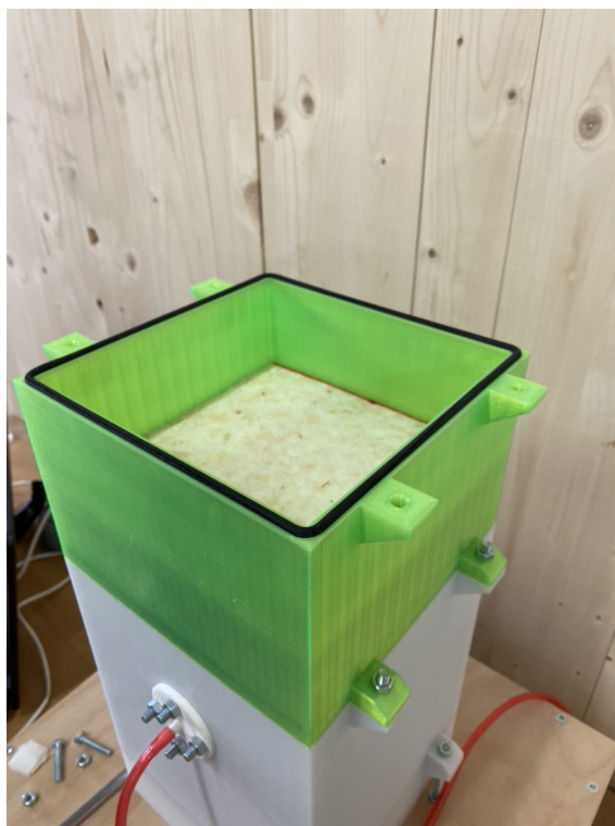
Obr. B.6: Pohled do buňky po umístění vzorku. [autor]
