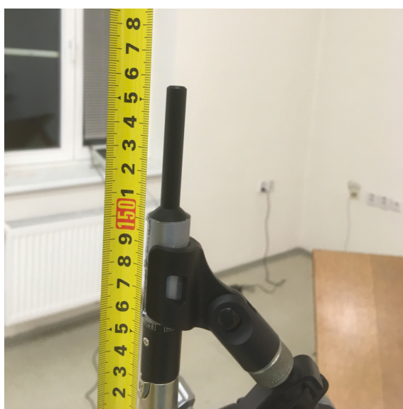
Obr. B.27: Měřící sestava - všesměrový měřící mikrofon. [autor]
