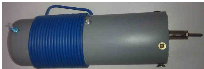
Obr. 35: Snímek navinuté cívky, v tabulce označené jako C, která byla využita při měření objemných vzorků hexogenu a \text{NaNO}_2 ve firmě Prototypa, a.s.; pro připojení do obvodu byla sonda vybavena anténním konektorem
