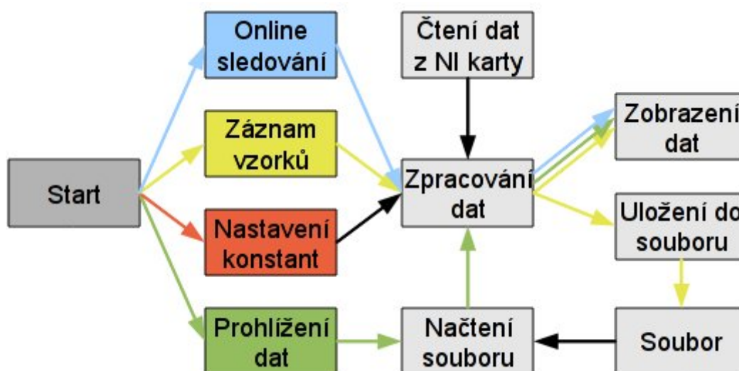
Obr. 6.1: Diagram programu (barevné šipky jsou průběhy čtyř základních částí programu, černé šipky jsou vyžádaná data).
