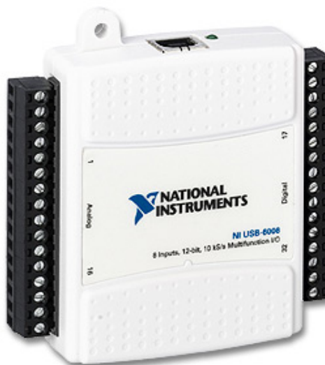
Obr. 5.1: Měřicí karta NI USB-6008, zdroj [10]
