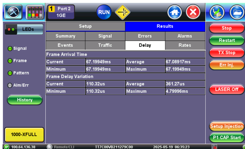
Obr. 7.10: Spuštěný BERT test s výsledky
