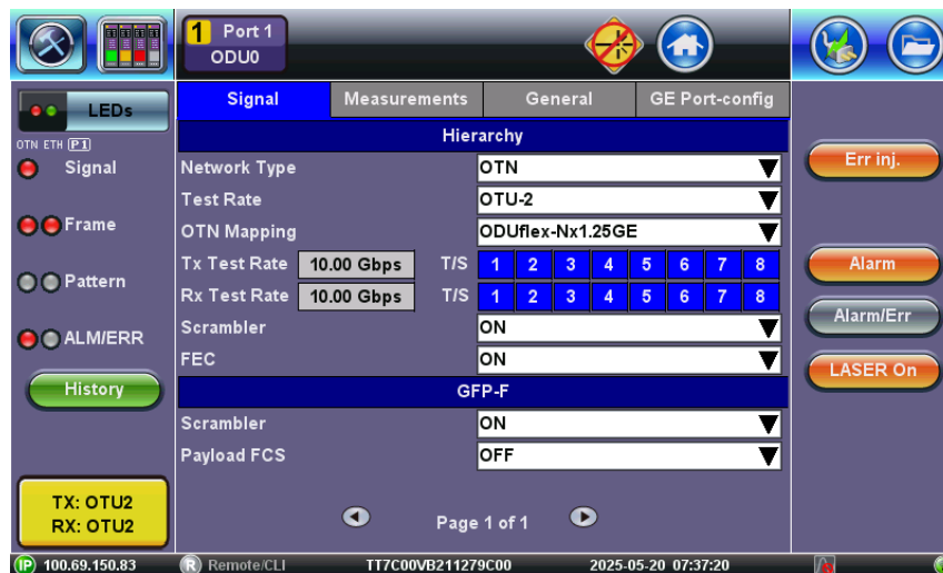
Obr. 7.13: Nastavení testu ODUflex s možností flexibilního přenosové rychlosti
